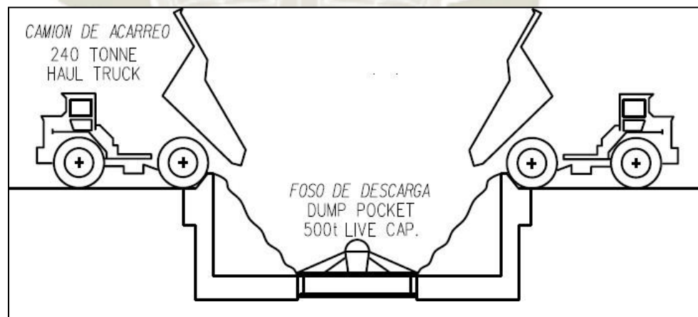
Figura 11: Esquema de operación del Dump Pocket. Fuente: FLUOR (2011).
