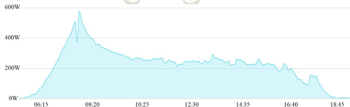
Figura 36 Comportamiento Sistema Fotovoltaico en Día Seminublado
