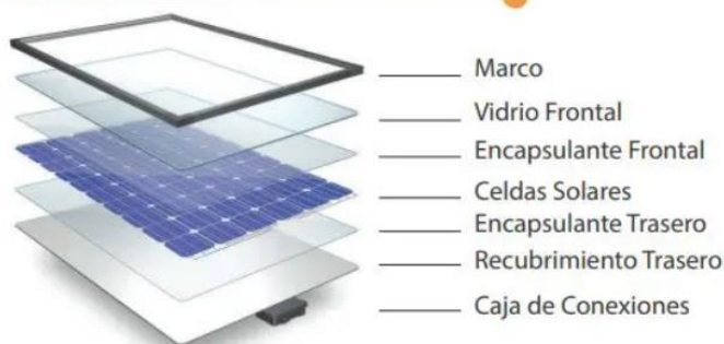
Figura 7 Características de un Panel Fotovoltaico.
