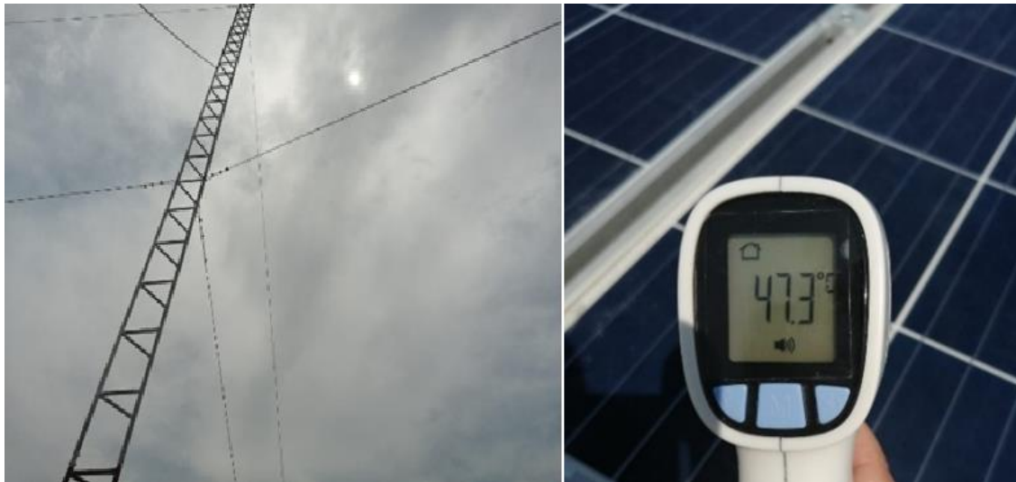
Figura 37 Temperatura del Panel Solar en Día Seminublado
