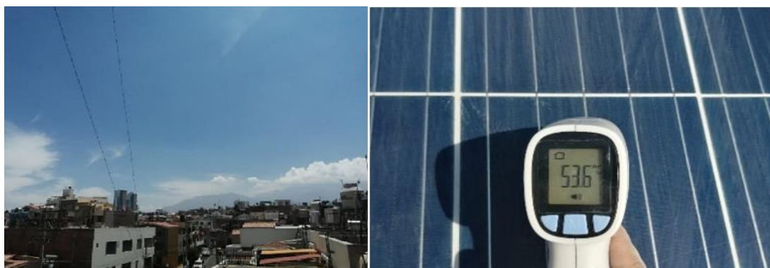
Figura 41 Temperatura del Panel Fotovoltaico en Días Soleados
