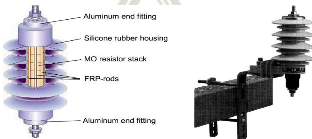
Figura N° 37. Partes del Apartarrayo
