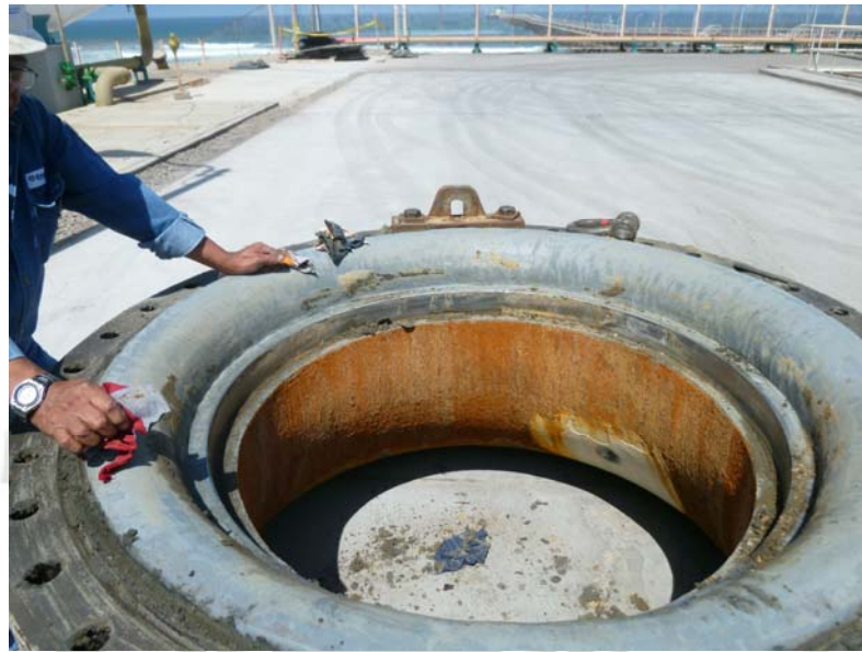
Figura 3.9. Foto de desgaste en el anillo de desgaste
