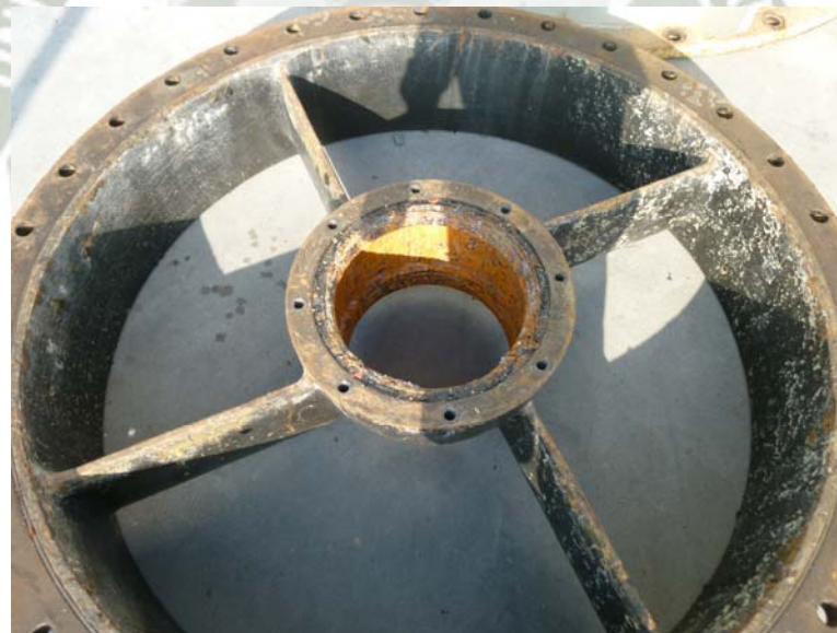
Figura 3.8. Foto de la bocina con corrosión y desgaste
