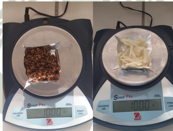
Figura 31. Pesado de bagazo de malta y bagazo de caña de azúcar.
