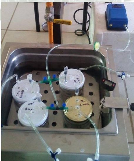
Figura 41. Sistema de medición de cinéticas de las cuatro cepas en estudio a 27°C.
