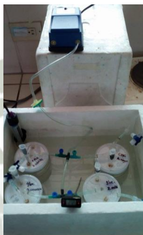
Figura 40. Sistema de medición de cinéticas de las cuatro cepas en estudio a 37°C.
