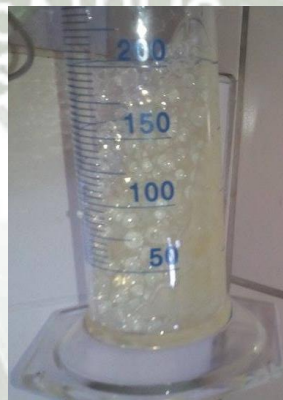
Figura 47. Extracto enzimático inmovilizado de A. niger en pellets de alginato de calcio
