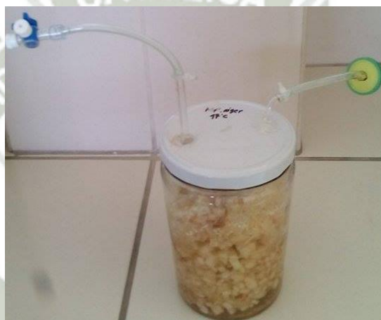
Figura 43. Sistema batch de A. niger a 17°C en bagazo de caña de azúcar.
