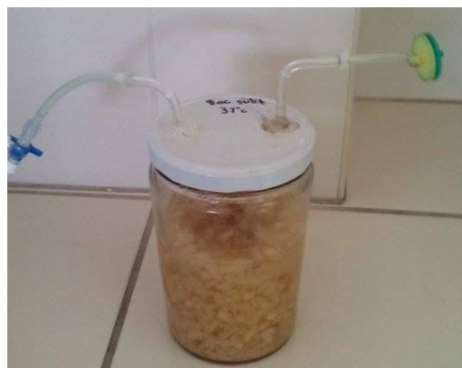
Figura 42. Sistema batch de B. subtilis a 37°C en bagazo de caña de azúcar.
