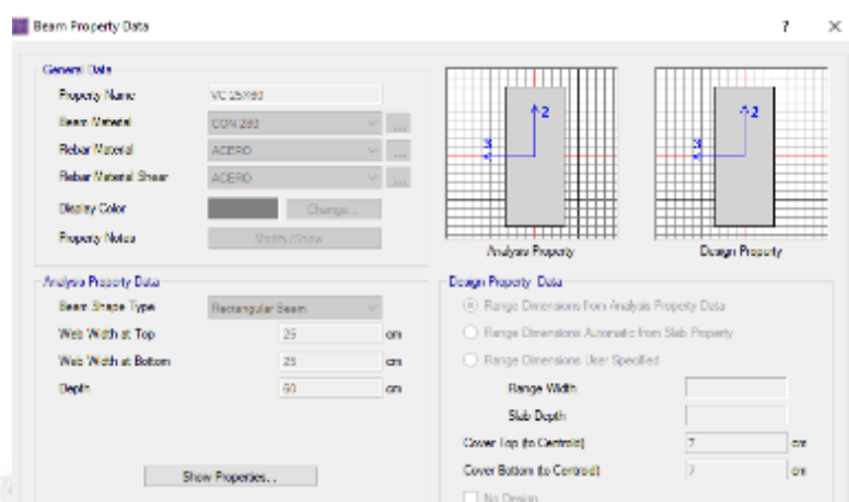
Figura 5.28 – Creación de viga de cimentación 25x60
