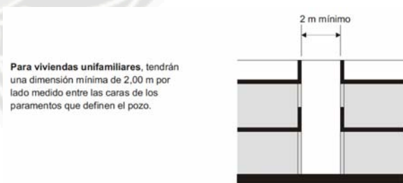
Figura 28: distanciamiento mínimo de pozo de iluminación para vivienda unifamiliar, fuente RNE.
