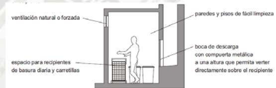
Figura 20: requerimientos mínimos para el diseño de los cuartos de basura, fuente RNE.
