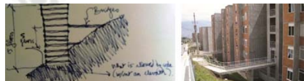
Figura 62: forma de uso de puentes como circulación y aprovechamiento de la pendiente que permite construir torres de más de 5 pisos sin necesidad de un ascensor.
