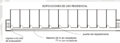
Distancia desde un departamento hacia una escalera de evacuación, (71 – 76m. , con y sin rociadores, respectivamente)
