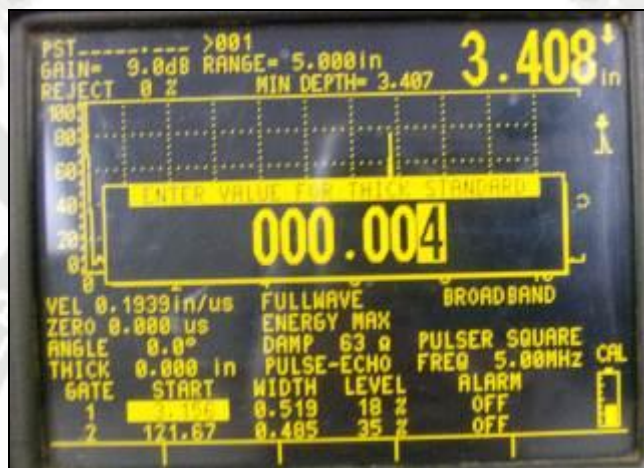
Fotografía N° 4 . Ingresando valor del segundo pico
