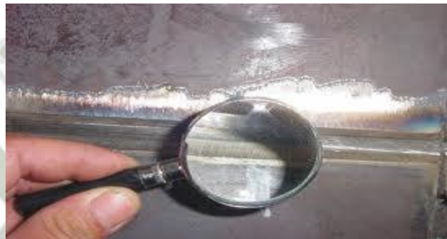
Figura 3.2. Ensayo Inspección visual
