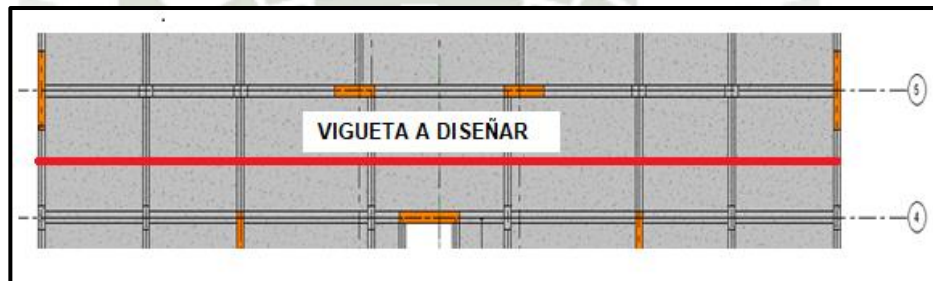
Figura N° 37 Losa Aligerada Entre Tramos 4 y 5
