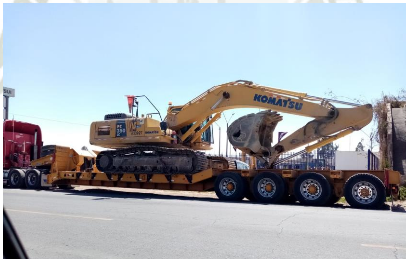
Figura 2.1 Cama baja 80 toneladas con cuello desmontable
