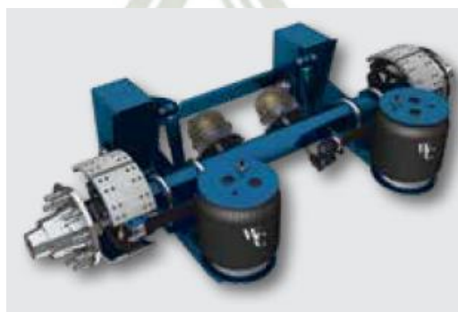
Figura 4.6 Suspensión Neumática con Brazos por debajo del Eje
