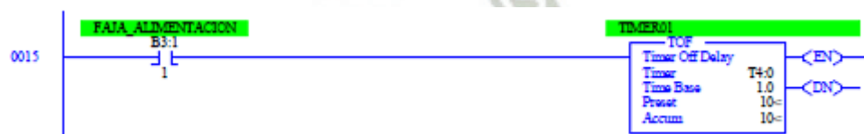
Figura N°38. Desarrollo de programación ladder, línea 0015
