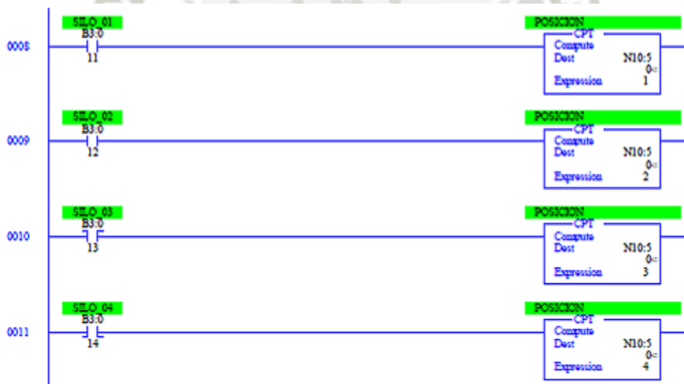
Figura N°34. Desarrollo de programación ladder, línea 0008,9,10,11
