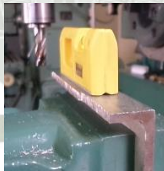
Figura 3-5: Proceso de fresado de los ángulos de acero para el PAT Fuente: Elaboración propia
