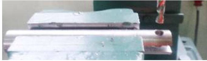
Figura 3-42: Proceso de taladrado de la palanca de accionamiento Fuente: Elaboración propia
