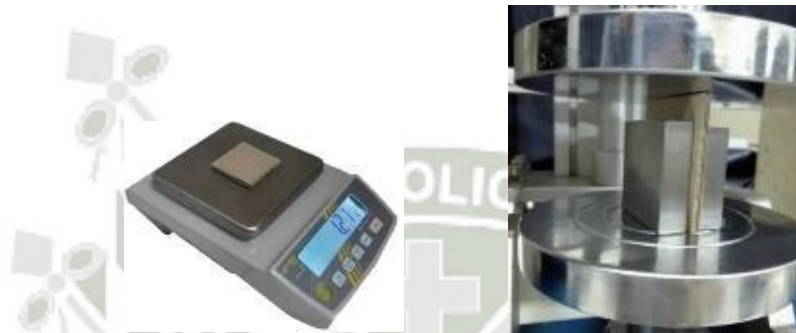
Figura 4-1: Medición del peso de la muestra para el ECT (izquierda) y sujeción de la muestra (derecha) Fuente: Elaboración propia
