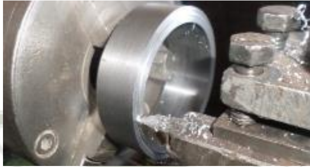
Figura 3-59: Proceso de cilindrado y refrentado de las cuchillas circulares en el torno Fuente: Elaboración propia
