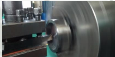
Figura 3-14: Proceso de mecanizado interior del bloque circular de acero ASTM A36 en el torno Fuente: Elaboración propia
