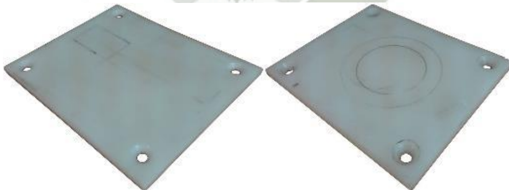
Figura 3-53: Placas receptoras PE-UHMW terminadas para los ensayos ECT, FCT, PAT y RCT Fuente: Elaboración propia
