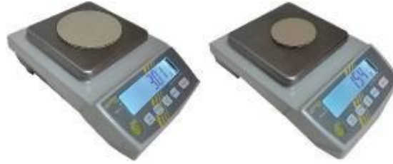
Figura 4-4: Medición del peso de las muestras para el FCT Fuente: Elaboración propia
