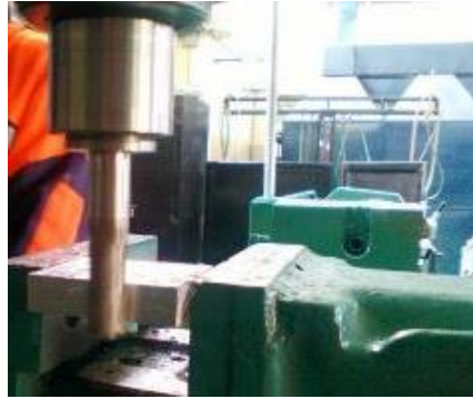
Figura 3-2: Maquinado de los bloques guía de INOX 316 con una fresa de espiga de 0.5pulg Fuente: Elaboración propia
