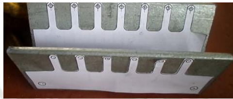
Figura 3-4: Angulo de acero utilizando planos impresos como guía. Fuente: Elaboración propia
