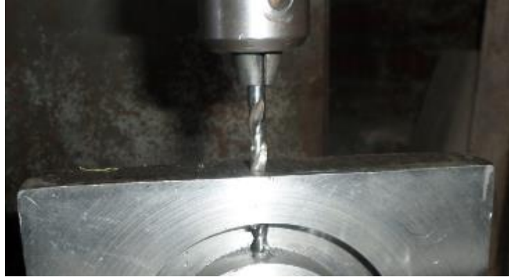
Figura 3-46: Proceso de perforado para el pin de traba de las cuchillas circulares del ensayo FCT Fuente: Elaboración propia
