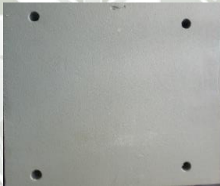
Figura 3-47: Agujeros roscados no pasantes del porta cuchilla circular Fuente: Elaboración propia
