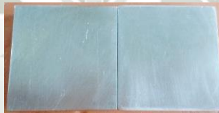
Figura 3-3: Bloques guía de INOX 316 terminados y pulidos Fuente: Elaboración propia
