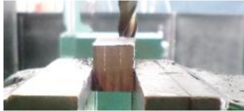
Figura 3-33: Proceso de fresado de las orejas del bastidor de la quijada Fuente: Elaboración propia
