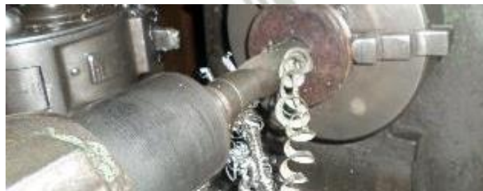
Figura 3-58: Proceso de perforado en el torno de la cuchillas circulares con una broca de 1\frac{1}{4} pulg Fuente: Elaboración propia
