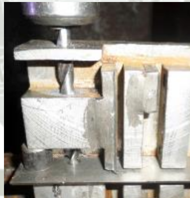
Figura 3-51: Proceso de taladrado con una broca de 6.5 mm del porta cuchilla rectangular Fuente: Elaboración propia
