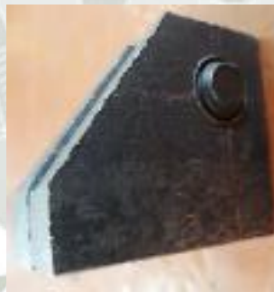
Figura 3-25: Orejas del bastidor de la mandíbula antes de limar. Fuente: Elaboración propia
