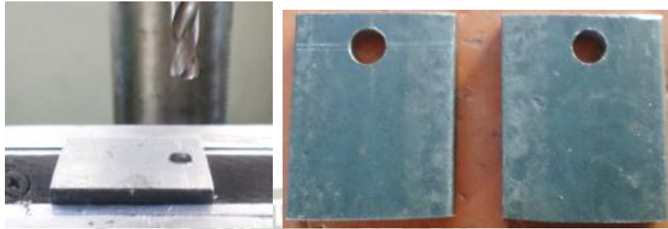
Figura 3-24: Proceso de taladrado de la orejas de la mandíbula (izquierda) y terminado (derecha) Fuente: Elaboración propia
