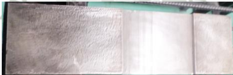
Figura 3-30: Proceso de cepillado terminado del Bastidor de la quijada Fuente: Elaboración propia
