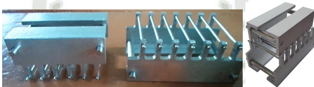
Figura 3-12: Accesorios del PAT terminados (izquierda) y montados (derecha) Fuente: Elaboración propia
