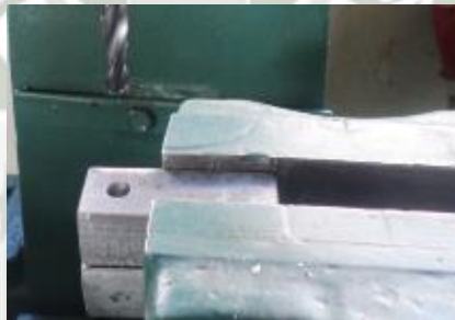
Figura 3-34: Proceso de taladrado pasante con una broca de \varnothing 12 mm aplicado a las orejas de la quijada Fuente: Elaboración propia
