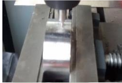
Figura 3-16: Proceso de taladrado con una broca de centrar al porta probeta circular Fuente: Elaboración propia
