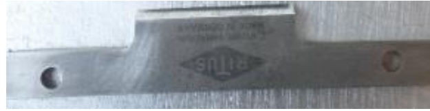
Figura 3-56: Corte de los lados no efectivos de la cuchillas Cr + V marca RITUS Fuente: Elaboración propia
