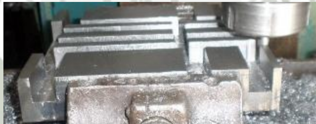
Figura 3-49: Proceso de fresado de los canales del porta cuchillas rectangular Fuente: Elaboración propia
