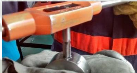
Figura 3-17: Proceso de roscado manual realizado a la porta probeta circular Fuente: Elaboración propia
