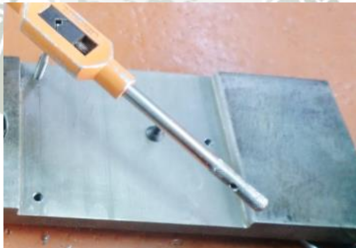
Figura 3-32: Proceso de roscado manual en el bastidor de la quijada Fuente: Elaboración propia
