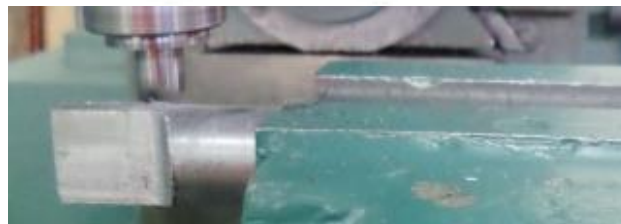
Figura 3-35: Proceso de fresado de la columna principal Fuente: Elaboración propia
