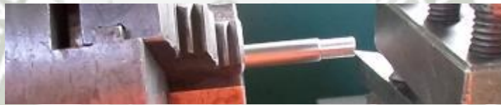
Figura 3-10: Proceso de cilindrado y refrentado de los pines guía INOX 303 Fuente: Elaboración propia
