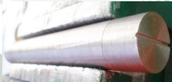
Figura 3-40: Traza recta con un arco de sierra manual para indicar la línea de proceso de fresado Fuente: Elaboración propia
