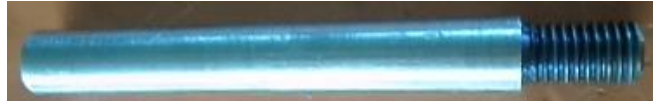
Figura 3-18: Mango de sujeción terminado de acero 1045 para sostener el porta probeta circular Fuente: Elaboración propia
