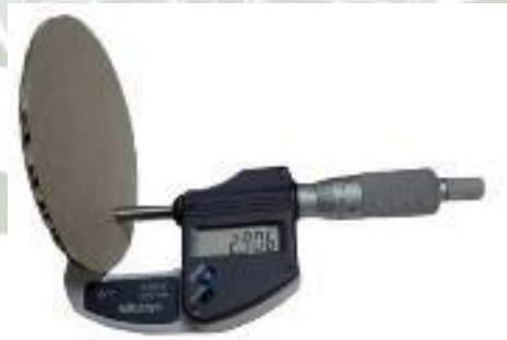
Figura 4-3: Medición del espesor del cartón corrugado para el FCT
