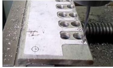
Figura 3-6: Proceso de perforado de los ángulos de acero Fuente: Elaboración propia
