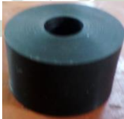
Figura 3-62: Gomas de apoyo de nitrilo para la troqueladora terminado Fuente: Elaboración propia
