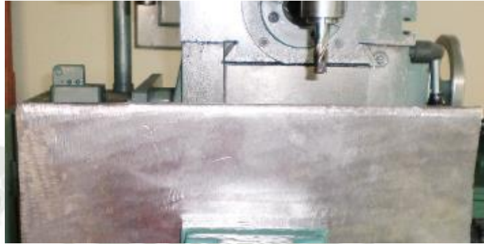
Figura 3-29: Proceso de fresado del bastidor de la quijada con una espiga de 0,5 pulg Fuente: Elaboración propia
