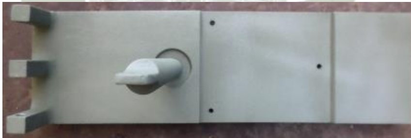
Figura 3-38: Orejas del bastidor y columna principal soldadas al bastidor de la quijada Fuente: Elaboración propia
