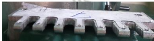
Figura 3-8: Proceso de fresado entre orejas de los ángulos Fuente: Elaboración propia
