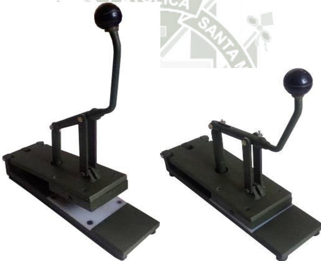
Figura 3-63: Troqueladora terminada, abierta (izquierda) y cerrada (derecha) Fuente: Elaboración propia
