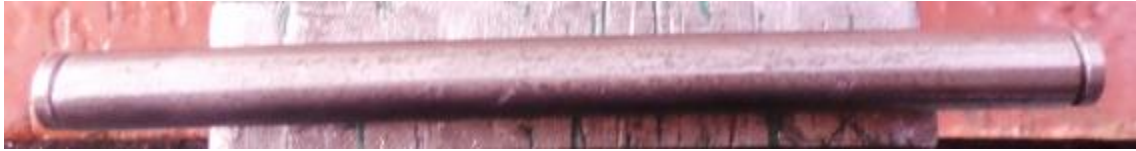
Figura 3-39: Pin de la articulación principal terminada Fuente: Elaboración propia
