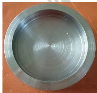
Figura 3-15: Porta probeta circular ASTM A36 pulido Fuente: Elaboración propia
