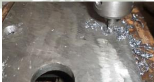
Figura 3-23: Proceso de avellanado aplicado al bastidor de la mandíbula Fuente: Elaboración propia
