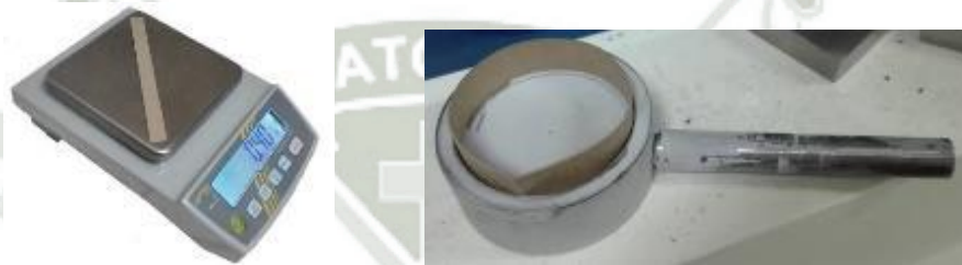
Figura 4-7: Medición del peso de la muestra para el RCT (izquierda) y posición del papel kraft sobre la ranura de la porta probetas circular en el RCT (derecha). Fuente: Elaboración propia
