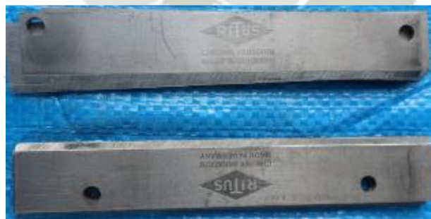
Figura 3-55: Perforado de las cuchillas de Cr +V marca RITUS Fuente: Elaboración propia
