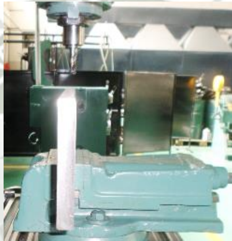
Figura 3-20: Proceso de Fresado del bastidor de la mandíbula Fuente: Elaboración propia
