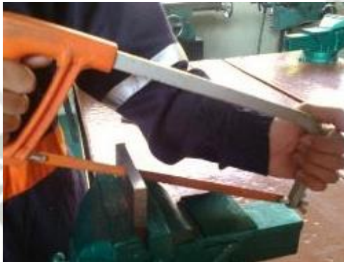
Figura 3-1: Corte realizado al bloque de INOX 316 con un arco de sierra. Fuente: Elaboración propia
