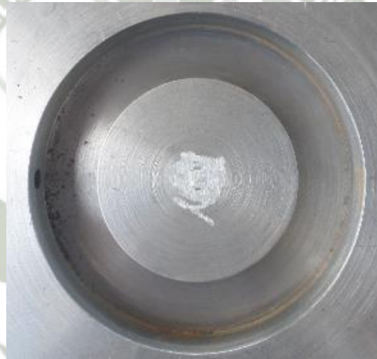
Figura 3-45: Porta cuchilla circular torneada para el ensayo FCT Fuente: Elaboración propia
