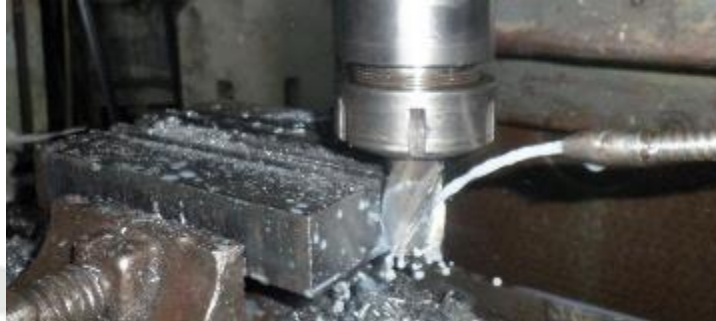
Figura 3-48: Proceso de fresado del porta cuchillas para los ensayos ECT, PAT y RCT Fuente: Elaboración propia
