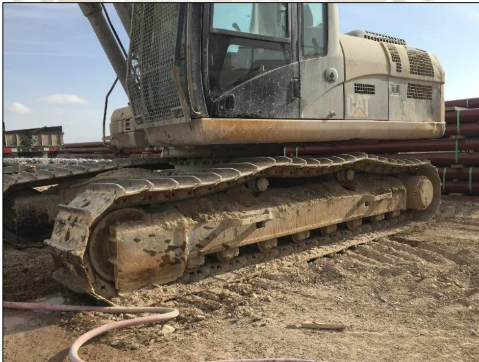
Excavadora 326D2L CAT trabajando en tierra
