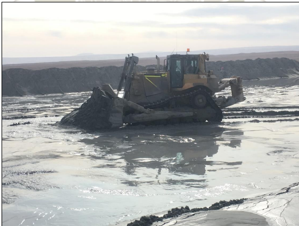
Tractor D8T CAT trabajando en un cancha de relave húmedo
