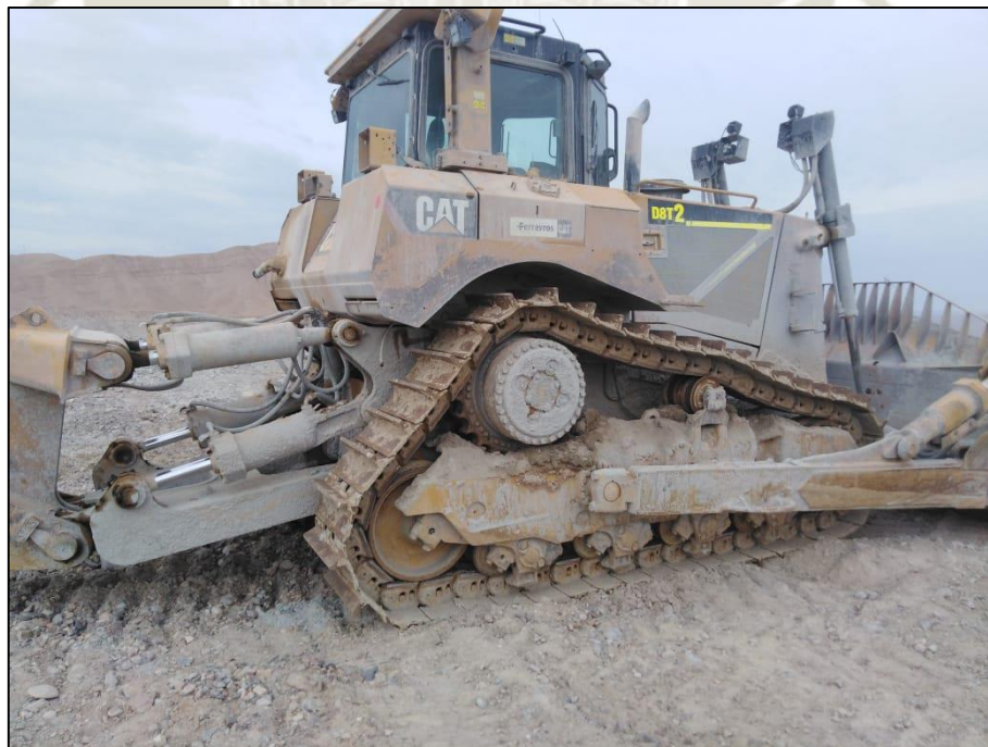
Tractor D8T CAT trabajando en tierra
