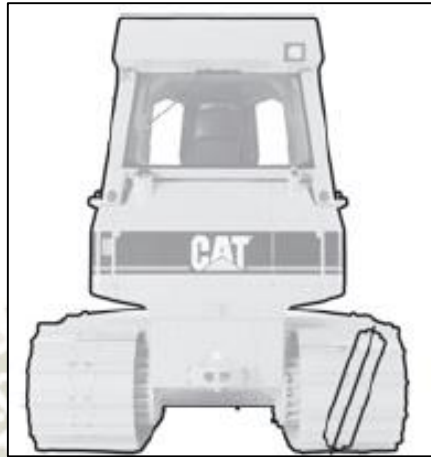
Figura 17. Torsión/inclinación de rueda guía
