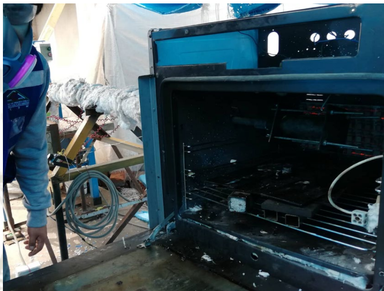
Figura 18 Horno y molde cilíndrico acoplado a la boca de la extrusora. (Fuente propia)
