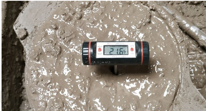
Termómetro digital para la medición de la temperatura en la mezcla fresca
