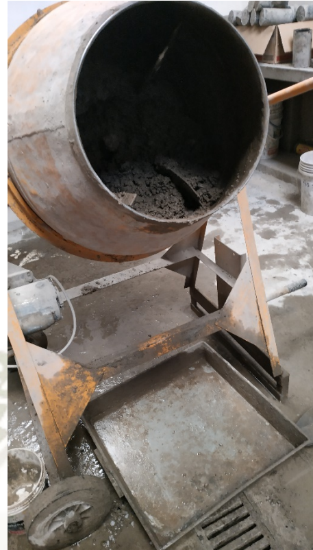
Mezcladora de 250 litros para la fabricación de concreto fresco
