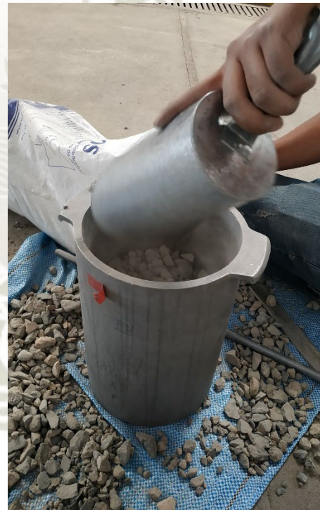
Olla de 1/3 de pie 3 para el peso unitario suelto y compactado
