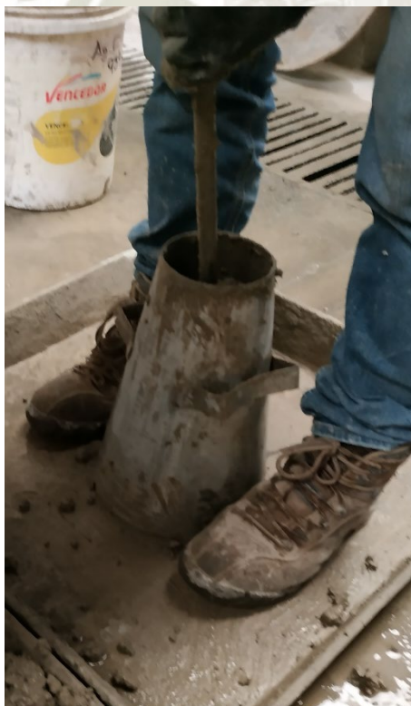
Cono de Abrams para el ensayo de asentamiento
