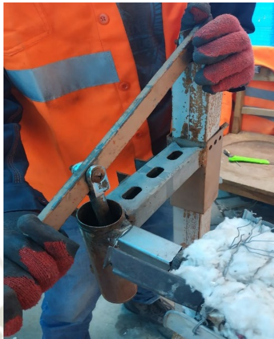
Figura 21 Proceso de corte del plástico extruido (Fuente propia)
