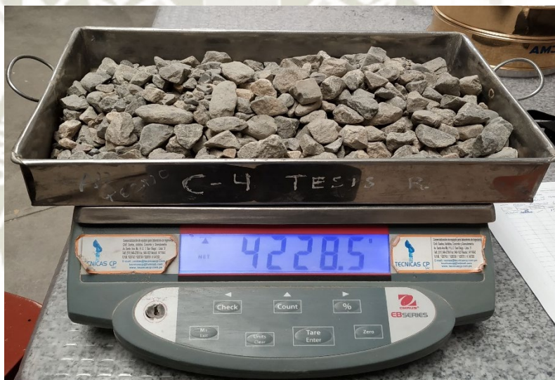
Balanza digital con exactitud de \pm 0.5g
