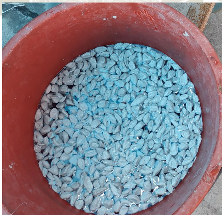
Figura 22 Agregado de HDPE extruido (Fuente propia)
