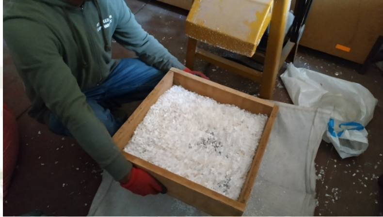
Figura 10 Tamizado de HDPE (Fuente propia)
