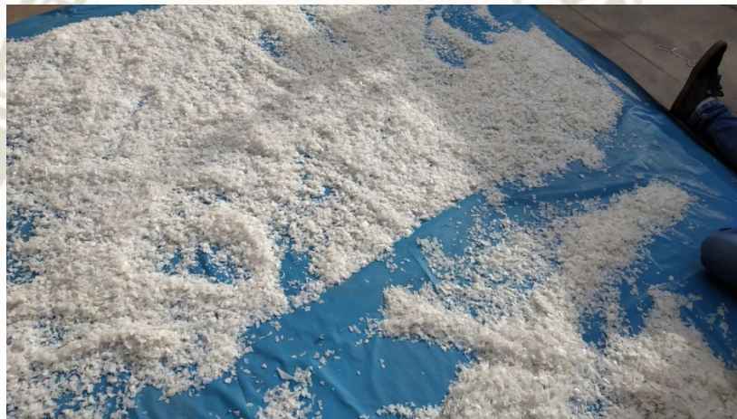
Figura 7 Secado del HDPE (Fuente propia)
