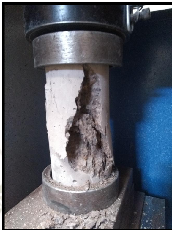
Imagen 21: Probeta ensayada en la prensa a compresión. Fuente: Elaboración propia.
