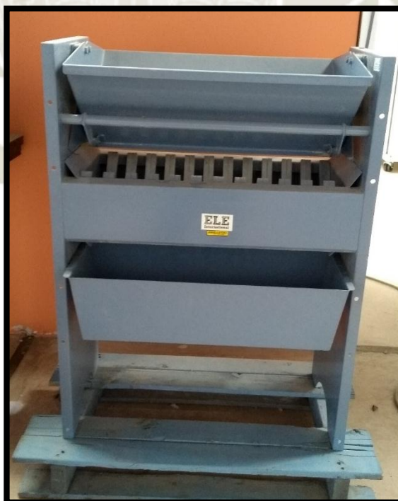
Imagen 8: Cuarteo del Agregado Grueso. Fuente: Elaboración propia.
