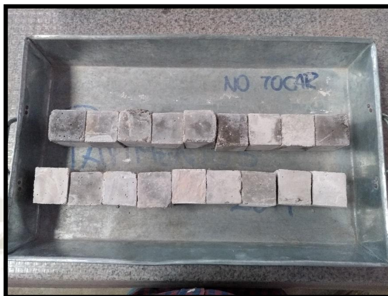
Imagen 22: Dados de concreto listos para ser ensayados. Fuente: Elaboración propia.
