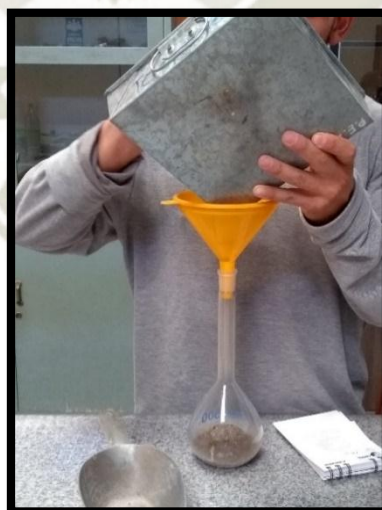
Imagen 10: Agregado fino en el picnómetro.
