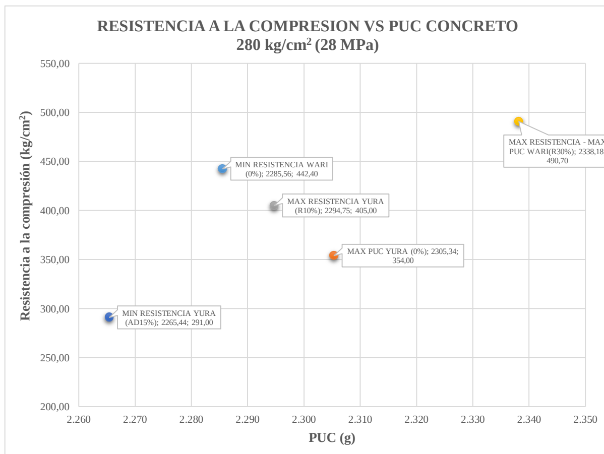
Gráfico 70: Resistencia a la compresión vs PUC concreto 280 \text{ kg/cm}^2 (28 MPa).
