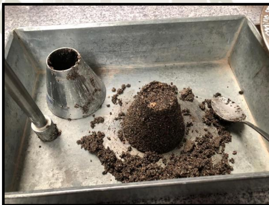
Imagen 12: Prueba de absorción del Agregado Fino. Fuente: Elaboración propia.
