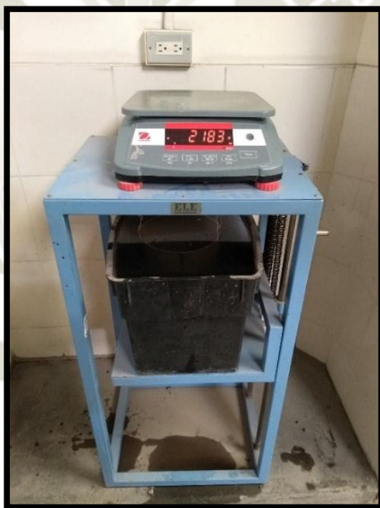
Imagen 14: Agregado Grueso sumergido para la prueba del peso específico.
