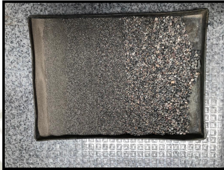
Imagen 9: Granulometría del Agregado Grueso. Fuente: Elaboración propia
