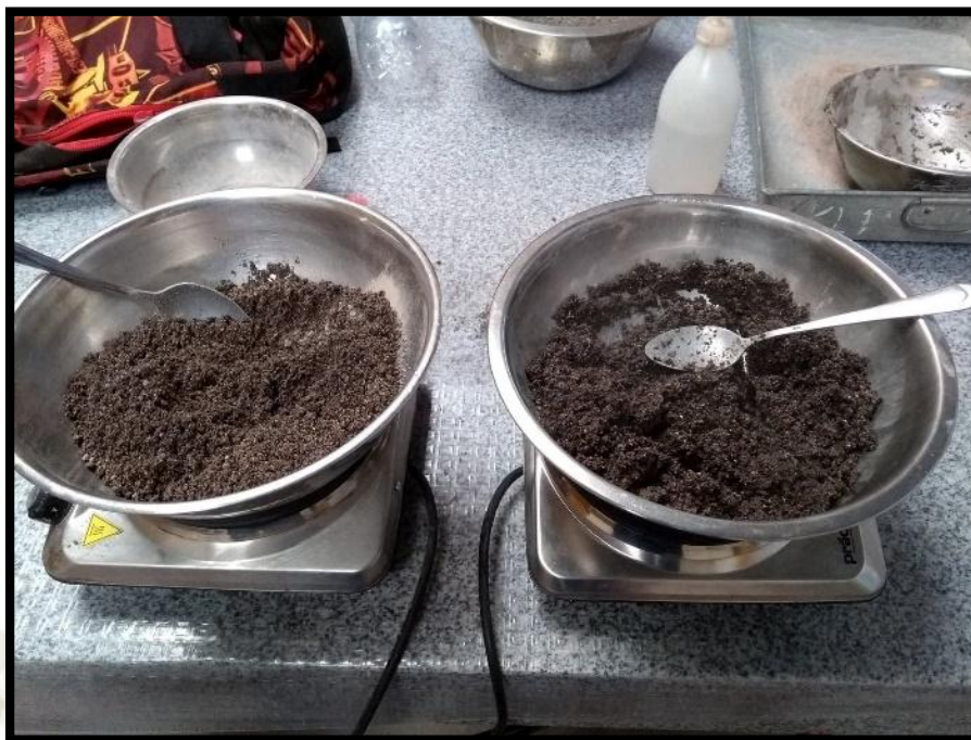
Imagen 11: Secado de las muestras de Agregado Fino. Fuente: Elaboración propia.
