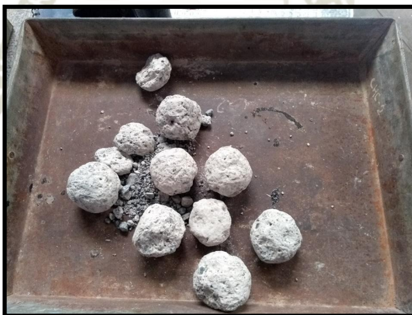
Imagen 23: Dados después de ser ensayados a la abrasión. Fuente: Elaboración propia.
