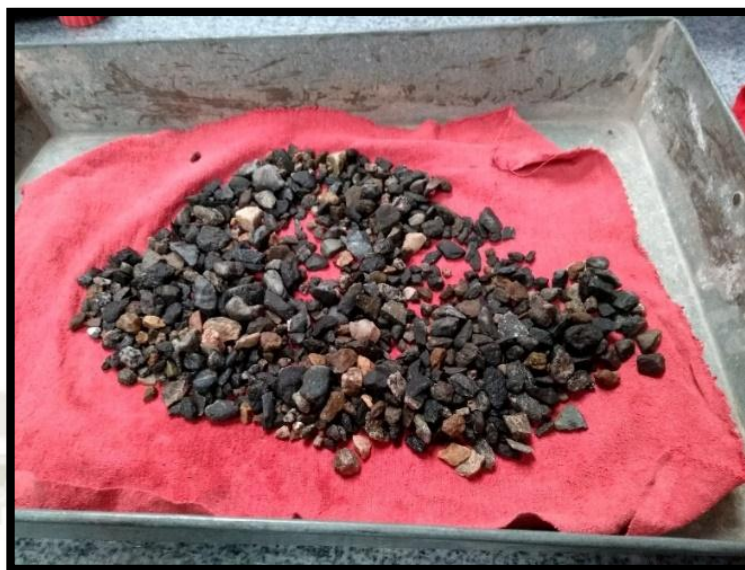
Imagen 15: Agregado Grueso Saturado. Fuente: Elaboración propia.
