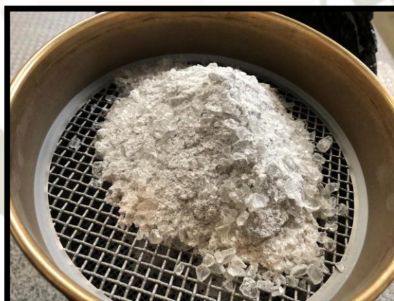
Imagen 6: Tamizado del vidrio. Fuente: Elaboración propia.
