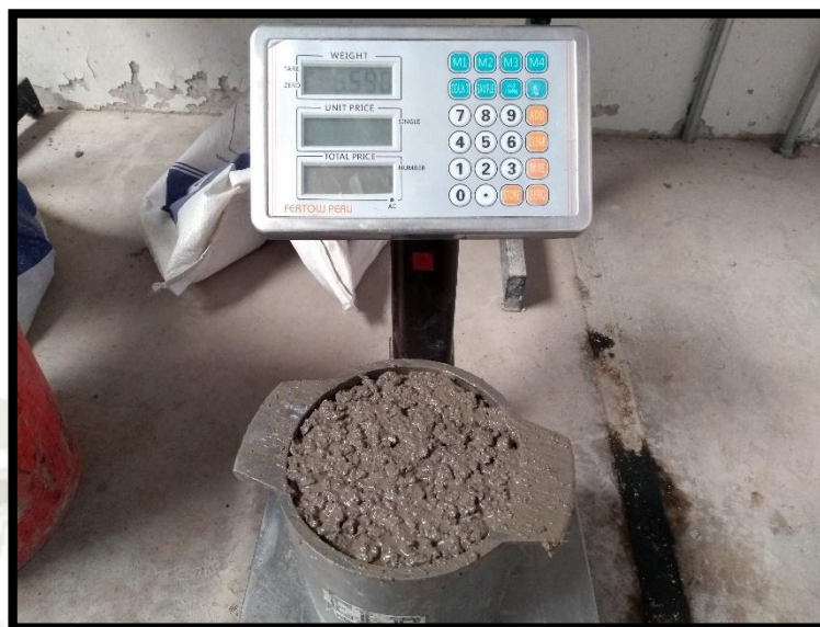
Imagen 19: Peso Unitario Suelto del Concreto. Fuente: Elaboración propia.
