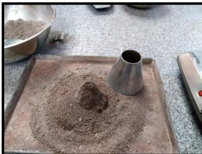
Imagen 13: Absorción del Agregado Fino Saturada Superficialmente Seca Fuente: Elaboración propia
