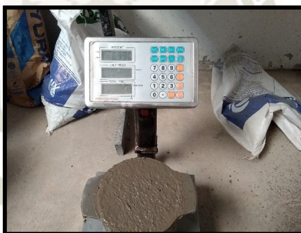
Imagen 20: Peso Unitario Compactado del Concreto. Fuente: Elaboración propia.
