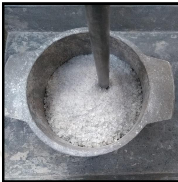
Imagen 17: Llenado y compactado del vidrio en olla de 1/10. Fuente: Elaboración propia.
