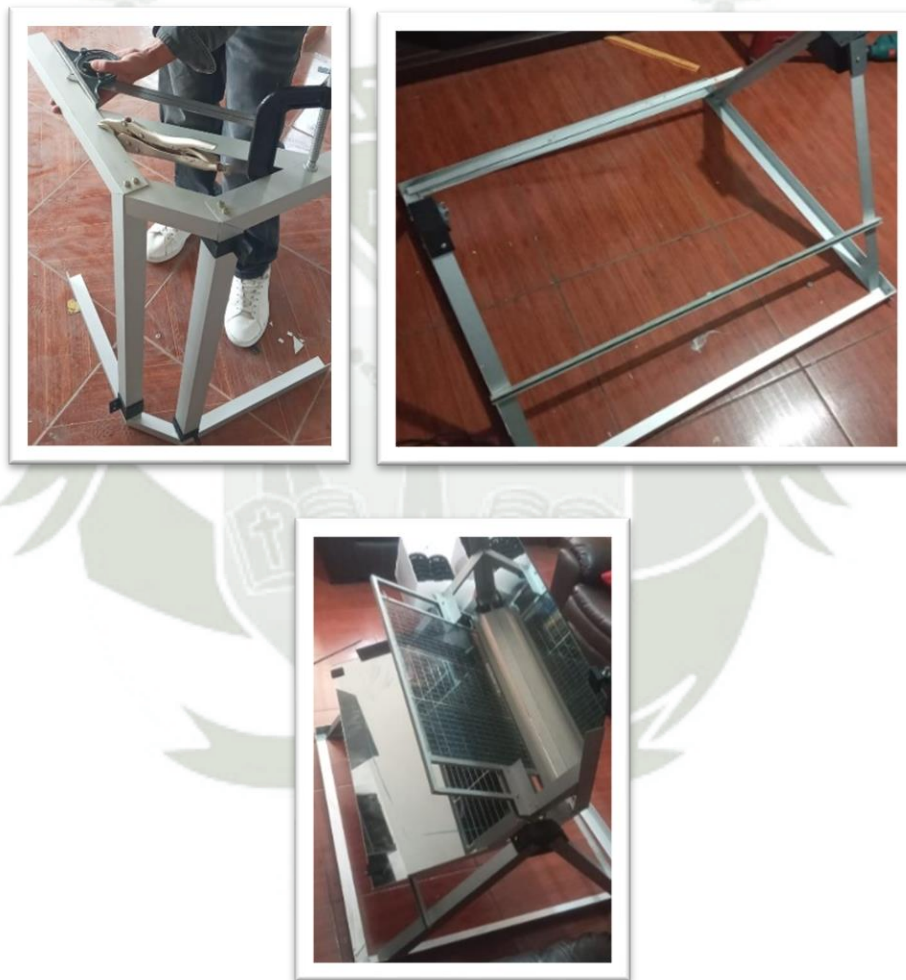
Figura 4.2. (a) Parte superior de la estructura , (b) Base de la estructura ensamblada y (c) Estructura terminada .
