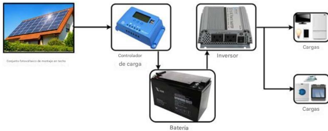
Figura 2.4. Partes de una instalación fotovoltaica.
