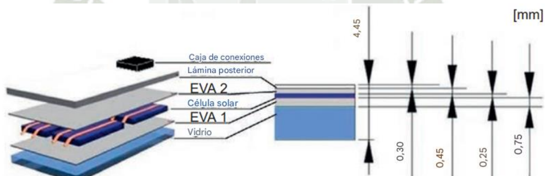
Figura 4.1. Estructura interna de un panel fotovoltaico.
