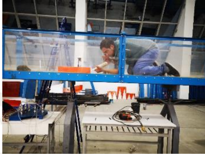
Fotografía 1. Instalación de Vertederos en canal hidrodinámico
