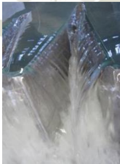
Figura 35 Interferencia de la lámina vertiente.
