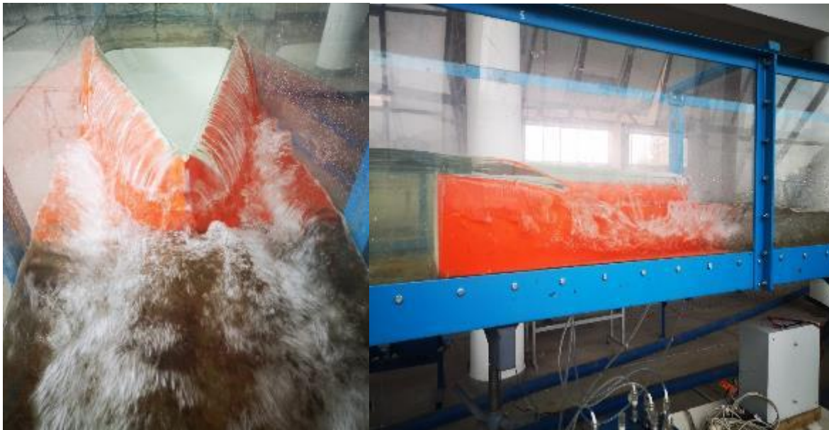
Fotografía 33. Vista frontal y lateral de vertedero en laberinto de 01 ciclo, 15°, P= 0.185\text{m} en funcionamiento. Q= 14\text{ L/s}
