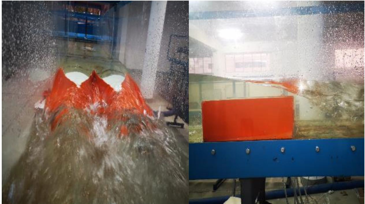
Fotografía 41 Sumersión Local (Vertedero 02 Ciclos Q=40L/s ) Fuente: Elaboración propia
