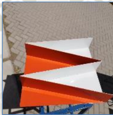
Fotografía 20. Acabado final de vertedero a ensayar
