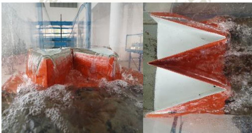
Fotografía 37. Vertedero en laberinto de 02 ciclos 20°, P= 0.11m. en funcionamiento Q= 15 L/s
