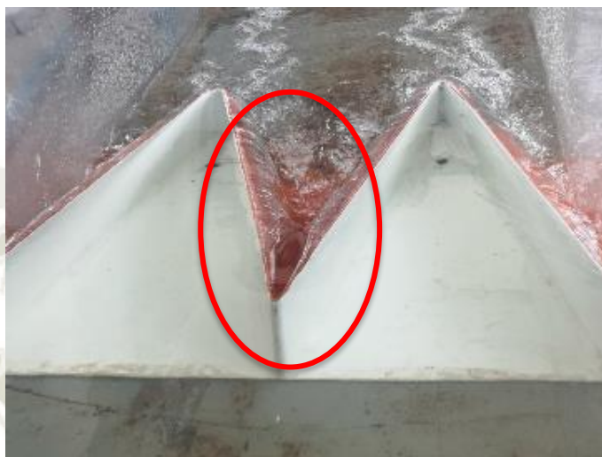
Fotografía 39. Longitud de interferencia (Vertedero de 02 ciclos, Q= 15 l/s) Fuente: Elaboración propia.
