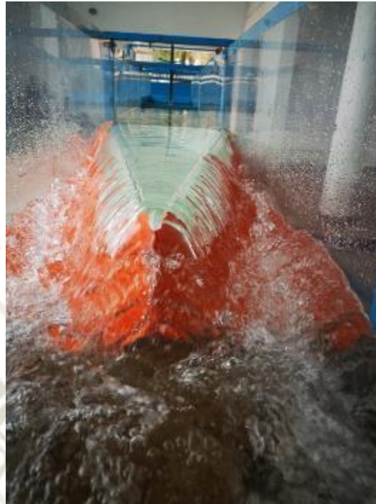
Fotografía 30. Vertedero en laberinto de 01 ciclo, 10^\circ , P = 0.185\text{m} . en funcionamiento Q = 41\text{ L/s}
