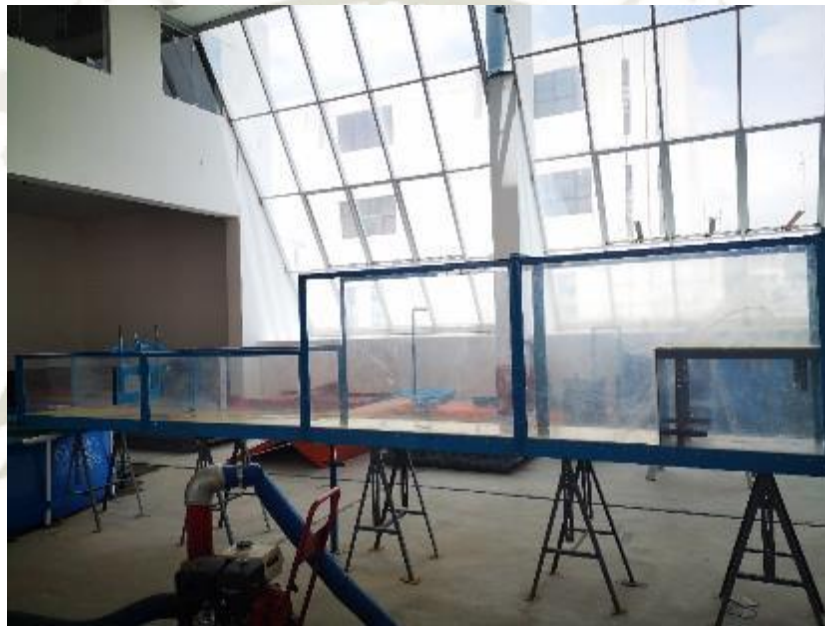
Fotografía 7. Canal Hidrodinámico aguas debajo del vertedero
