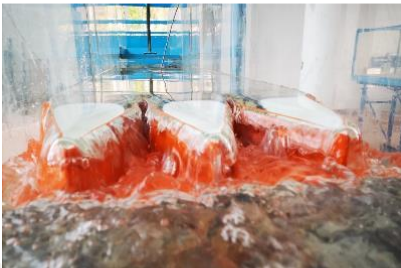
Fotografía 35. Vertedero en laberinto de 03 ciclos, 15°, P= 0.075m. en funcionamiento. Q= 12 L/s
