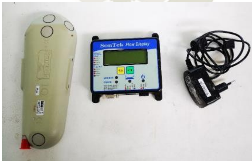
Fotografía 29. Caudalímetro Son Tek IQ, Display de datos, y alimentador de energía
