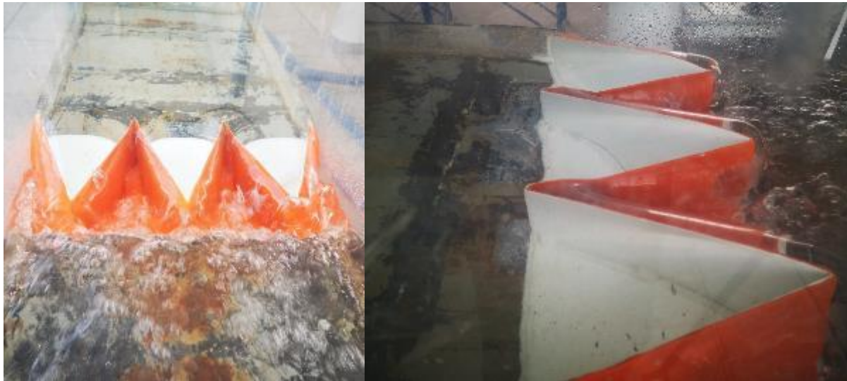
Fotografía 38. Vertedero en laberinto de 03 ciclos 20^\circ , P= 0.075m . en funcionamiento Q= 14 L/s
