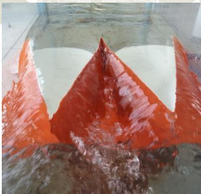
Fotografía 40. Intersección de láminas vertientes (Vertedero de 02 Ciclos, Q= 30 L/s.) Fuente: Elaboración propia
