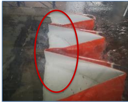
Figura 32 Interferencia de láminas vertientes Fuente Elaboración propia
