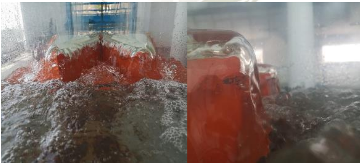
Fotografía 34. Vista frontal y lateral (condición de "cavidad" de napa vertiente sobre la cresta del vertedero) del vertedero en laberinto de 02 ciclos, 15° P= 0.11m, en funcionamiento Q= 15 \text{ L/s}
