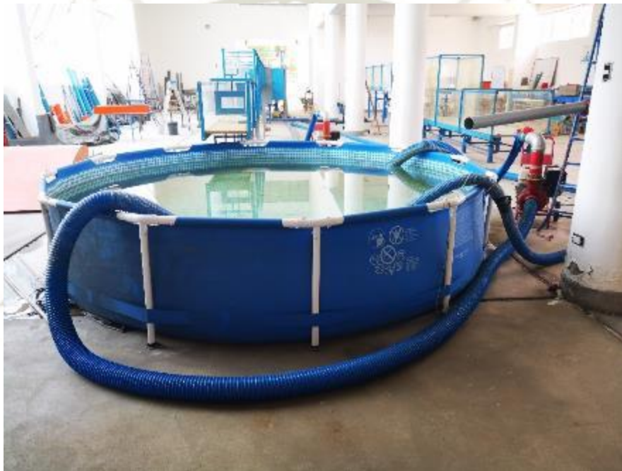
Fotografía 10. Piscina de almacenamiento y punto de alimentación
