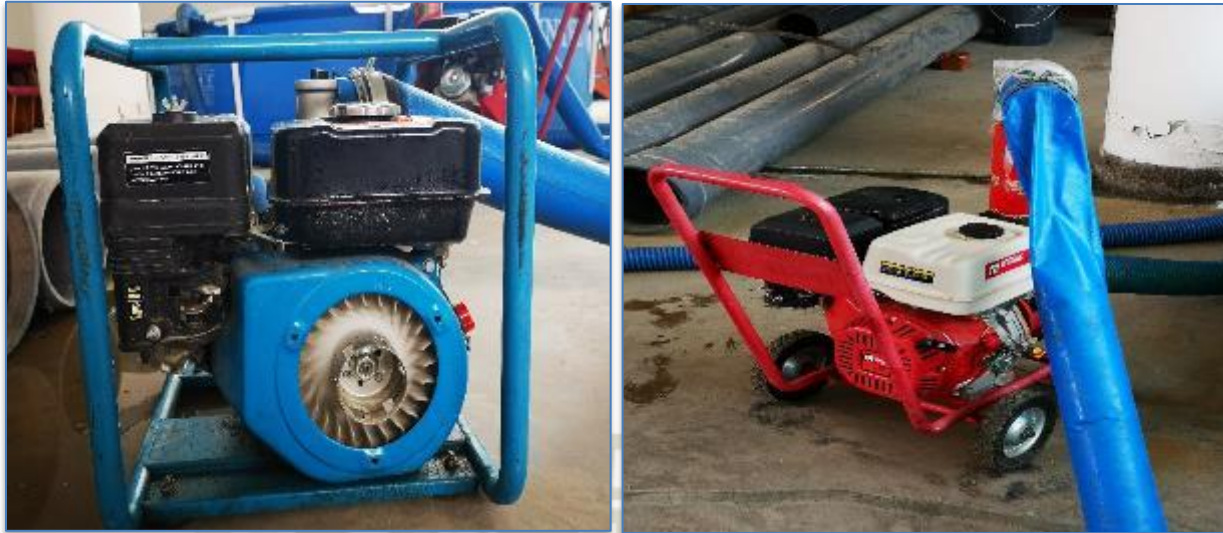
Fotografía 8. Motobomba de 7 HP y 15 HP
