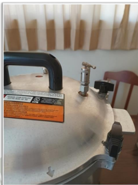
Anexo 8: Apertura de válvula de aire.
