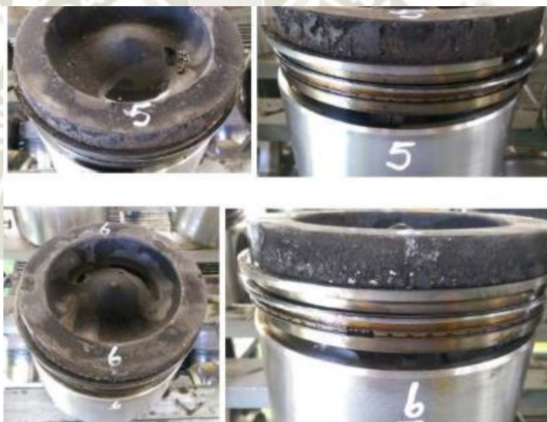
Imagen N° 59: Carbonilla en la circunferencia de la cabeza de los pistones
