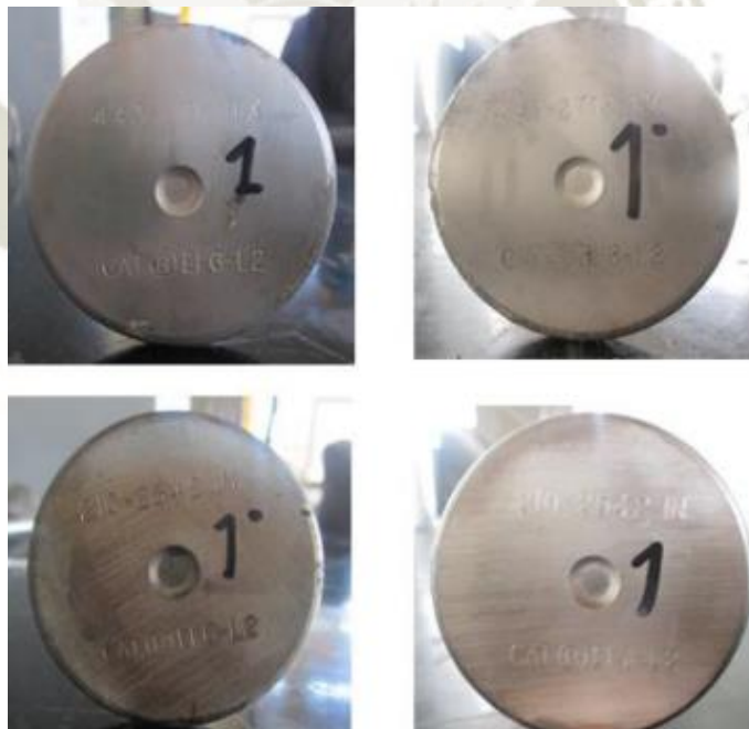
Imagen N° 79: Cara inferior de válvulas de escape
