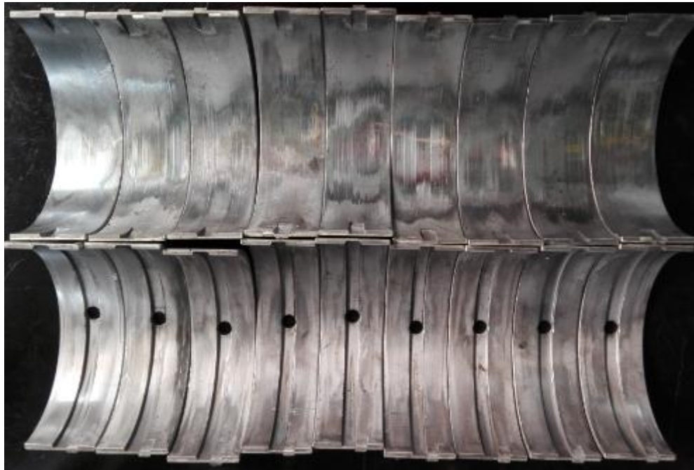
Imagen N° 52 Condición típica de metales de bancada
