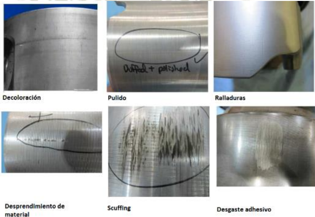
Imagen N° 35: Desgaste en la falda
