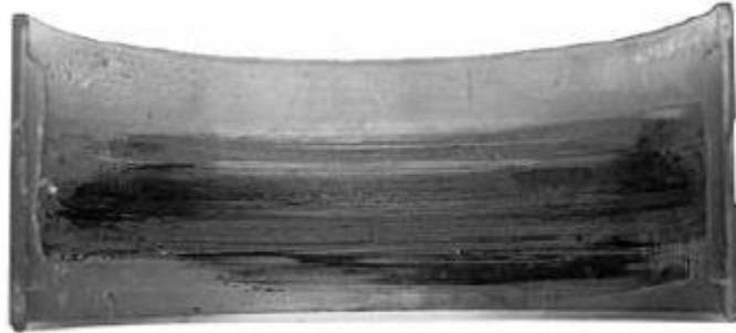
Imagen N° 27: Desgaste por falta de lubricación
