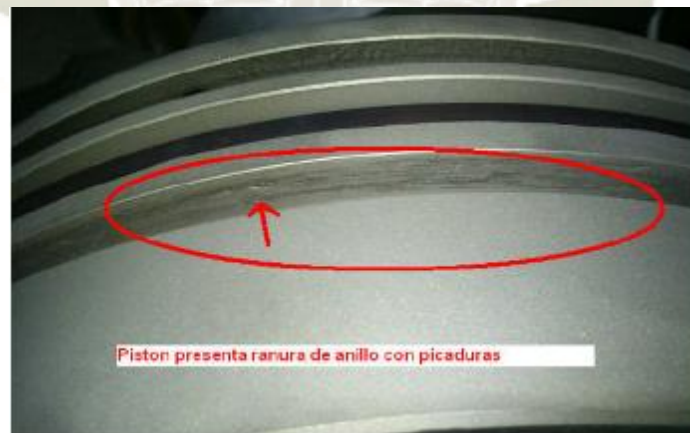
Imagen N° 233: Picaduras en anillo del pistón del camión 159
