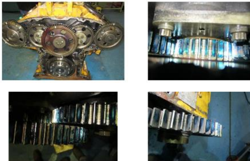
Imagen N° 83 Patrón de asentamiento de engranajes bueno
