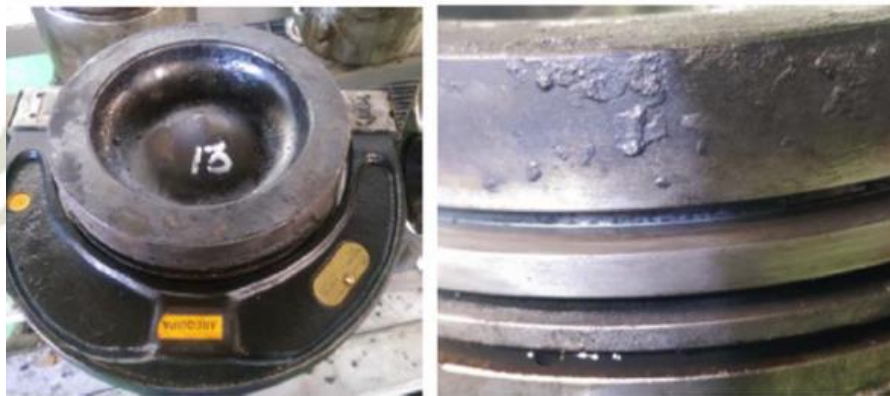
Imagen N° 64: Medición de alojamiento de anillos con desgaste en pistón
