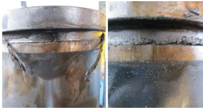
Imagen N° 65: Sellos superiores de camisas resacos y rotos
