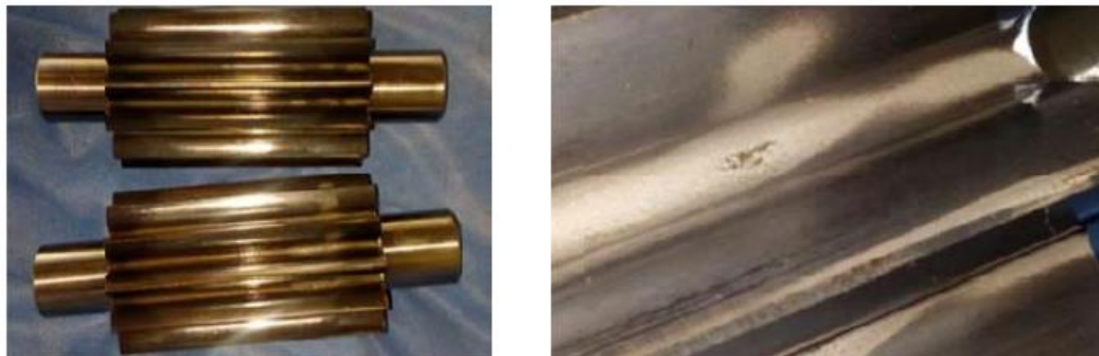
Imagen N° 87: Erosión por cavitación en eje
