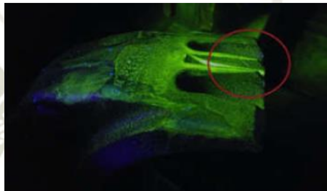
Imagen N° 55 Fisuras encontradas en las bielas
