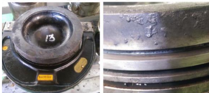
Imagen N° 243: Alojamiento del anillo con desgaste del camión 156
