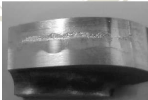
Imagen N° 21: Desgaste por fatiga de contacto
