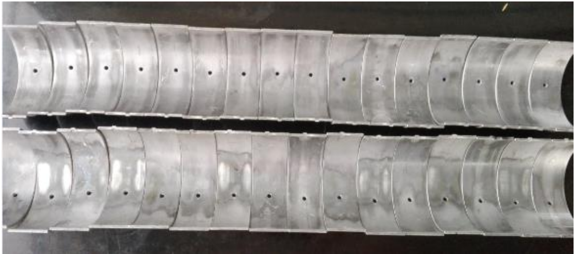
Imagen N° 51 Condición típica de los metales biela
