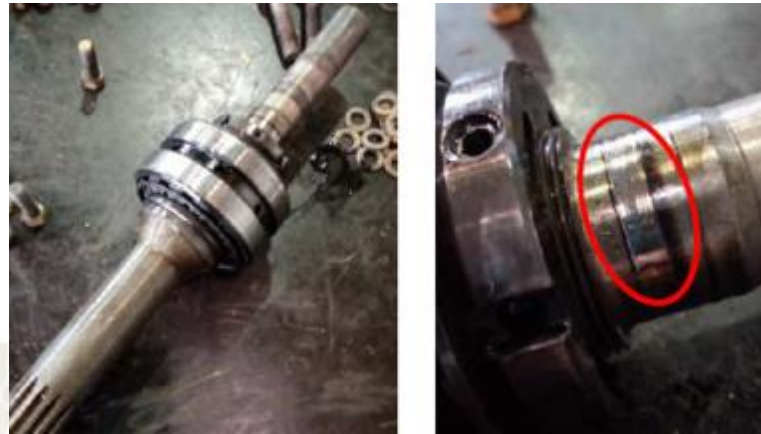
Imagen N° 89: Desgaste en el eje de bomba de agua principal
