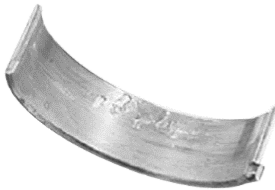
Imagen N° 28: Fatiga de contacto en cojinetes
