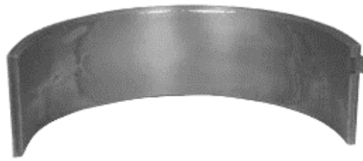
Imagen N° 25: Desgaste típico de un cojinete
