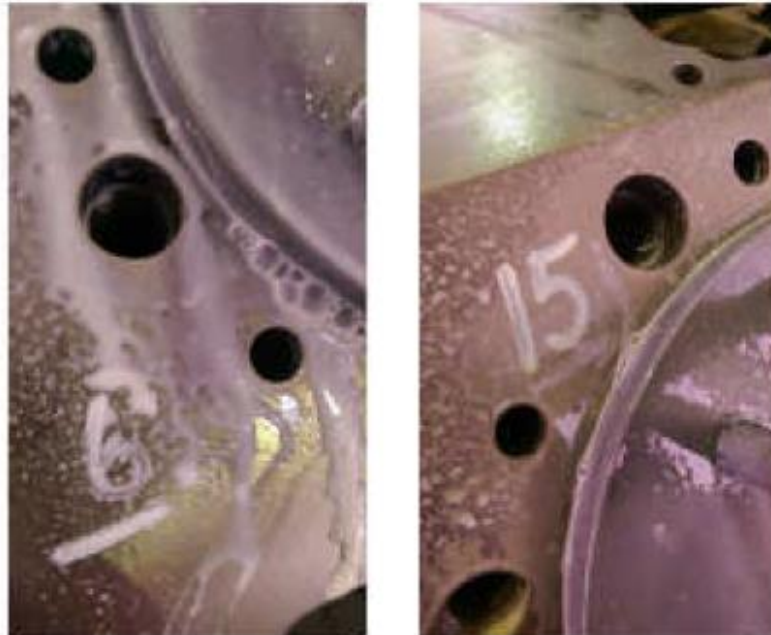
Imagen N° 179: Presurización de insertos camión 123
