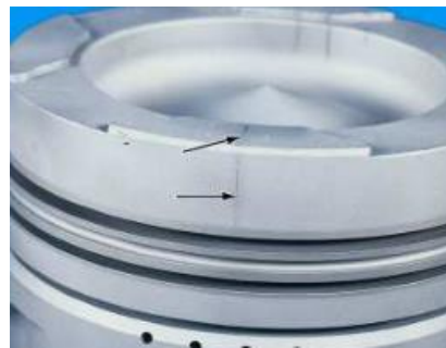
Imagen N° 36: Fisuras en pistones
