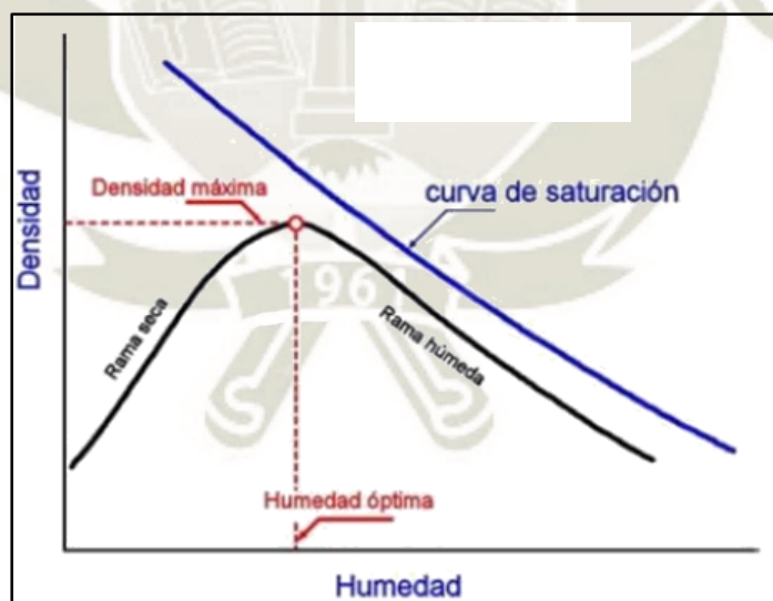
Ilustración 18 Curva de Compactación con Curva de Saturación
