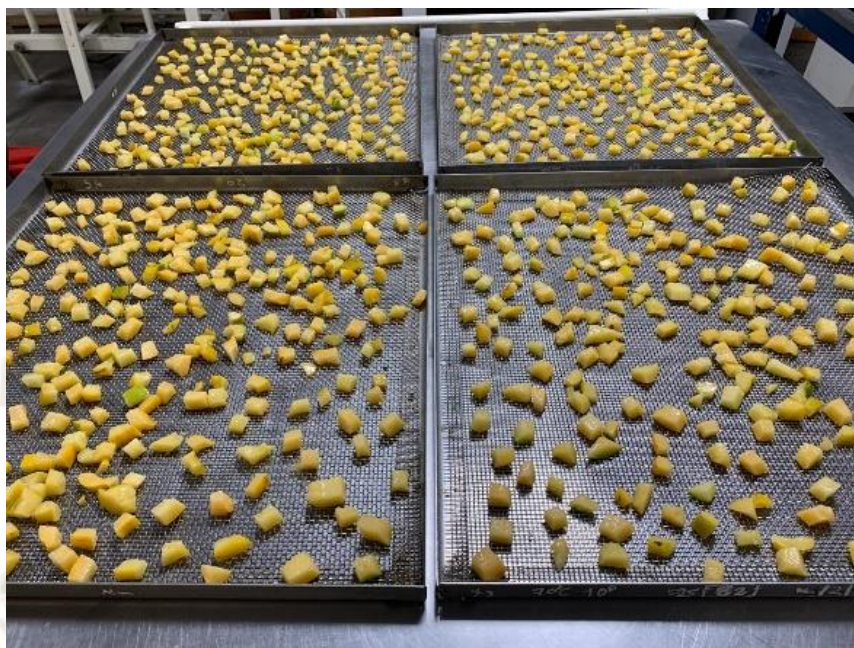
Materia prima: papaya arequipeña en bandejas, trozada en cubos y lista para secarse
