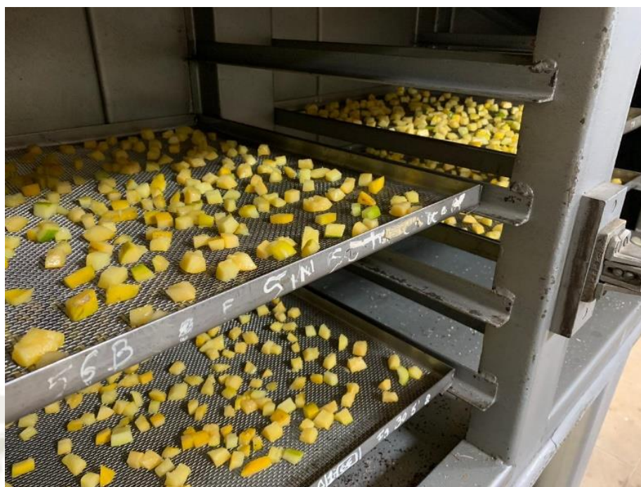
Materia prima: papaya arequipeña en bandejas, trozada en cubos en el secador
