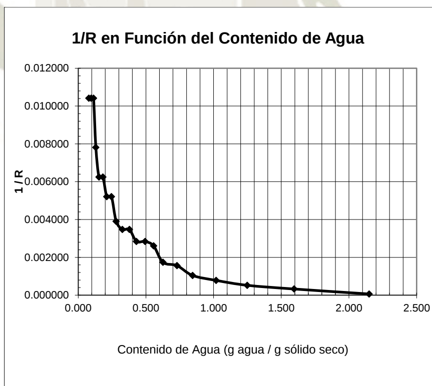
Gráfico 4: 1/R en función del contenido de humedad para el tamaño de corte de 0.5 cm x 0.5 cm
