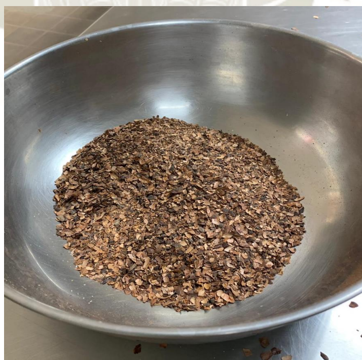
Tamizado de cáscara de cacao en malla de 30
