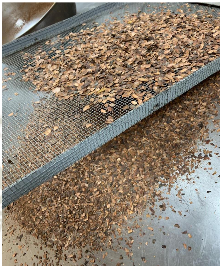
Tamizado de cáscara de cacao en malla de 30
