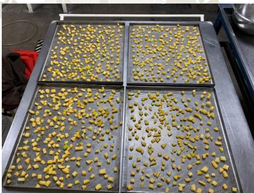
Materia prima: papaya arequipeña en bandejas, trozada en cubos y lista para secarse
