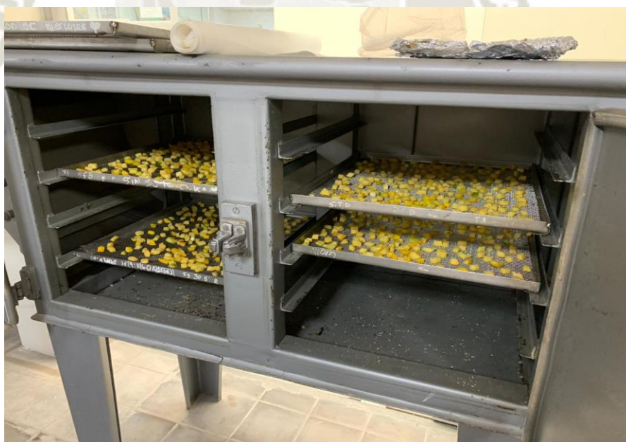
Materia prima: papaya arequipeña en bandejas, trozada en cubos en el secador
