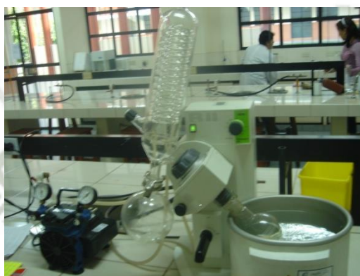
Figura N° 2.4. Rotavapor usado para volatilizar los solventes de los extractos
