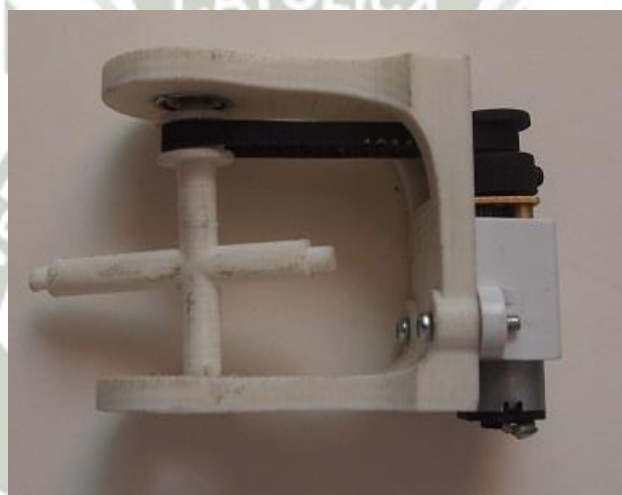
Figura 3. 33 Impresión del ensamblaje de la muñeca con fajas síncronas Fuente: Elaboración propia
