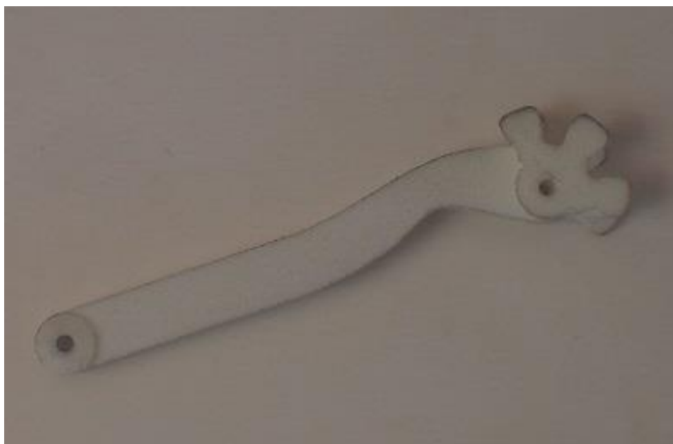
Figura 3. 23 Impresión 3D del engrane fusionado al actuador proximal de la falange distal del dedo medio
