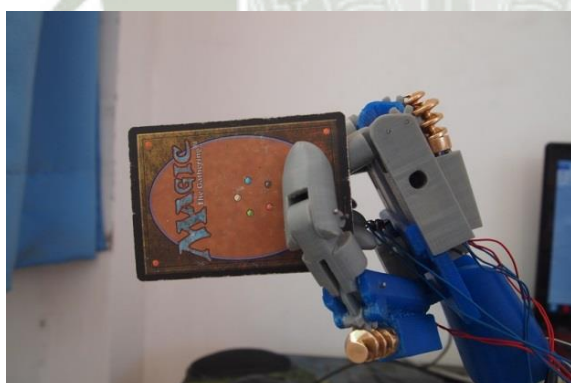
Figure 3. 37 Prótesis con prensión por oposición subterminolateral Fuente: Elaboración propia
