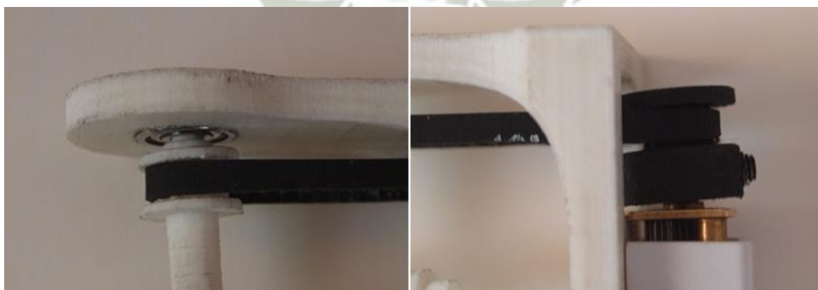
Figura 3. 34 acercamiento de los lugares de sujeción de la faja síncrona. Fuente: Elaboración propia
