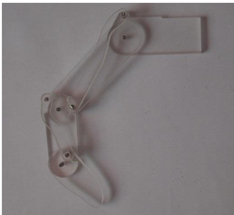
Figura 3. 12 Dedo de acrilico basado en el sistema de 4 eslabones en medio de la trayectoria Fuente: Elaboración propia
