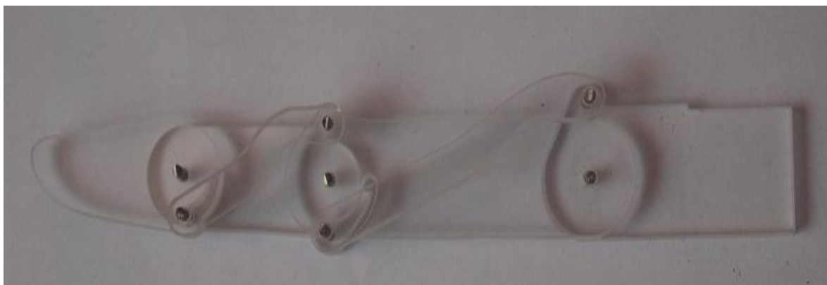
Figura 3. 10 Dedo de acrílico armado basado en el sistema de eslabonamiento de 4 eslabones Fuente: Elaboración propia
