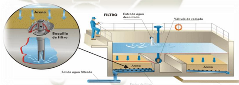
FIGURA 1.3: FILTRO ABIERTO DE ARENA TIPO AQUAZUR
