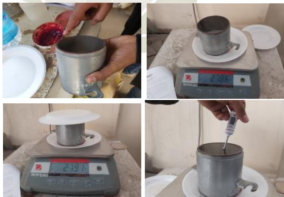
Fotografía 22, Calibración de molde de compactación.
