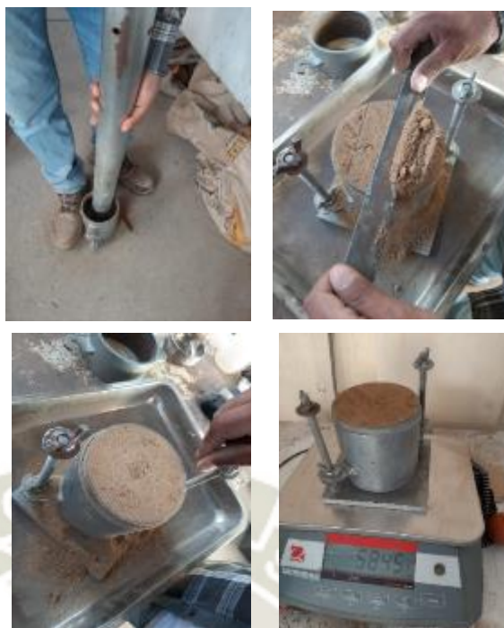
Fotografía 23, Ensayo de compactación de suelo NTP
