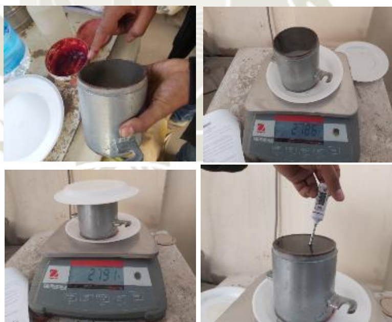
Fotografía 26, Calibración de molde de compactación
