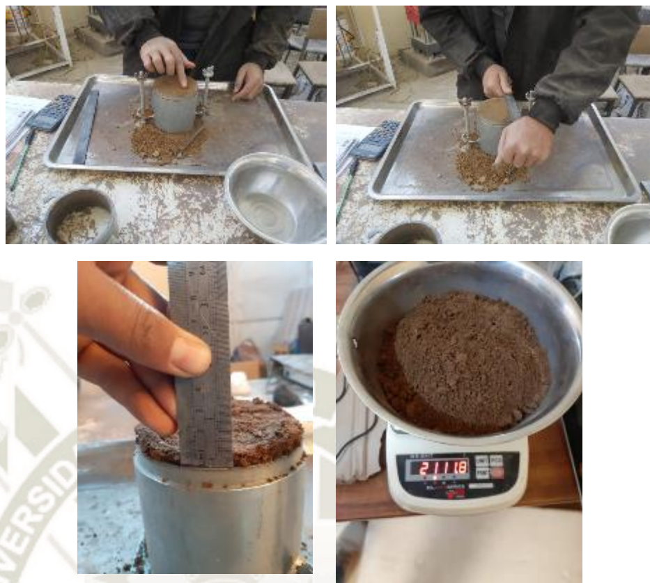
Fotografía 25, Ensayo de compactación de suelo MTC
