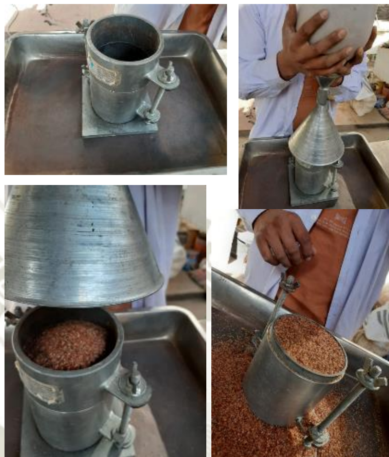
Fotografía 34, Calibración de la densidad de la arena ASTM
