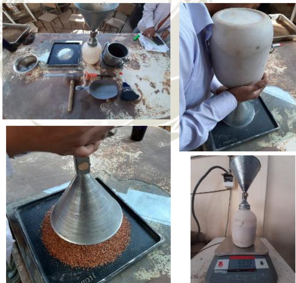
Fotografía 29, Calibración del aparato de cono de arena NTP
