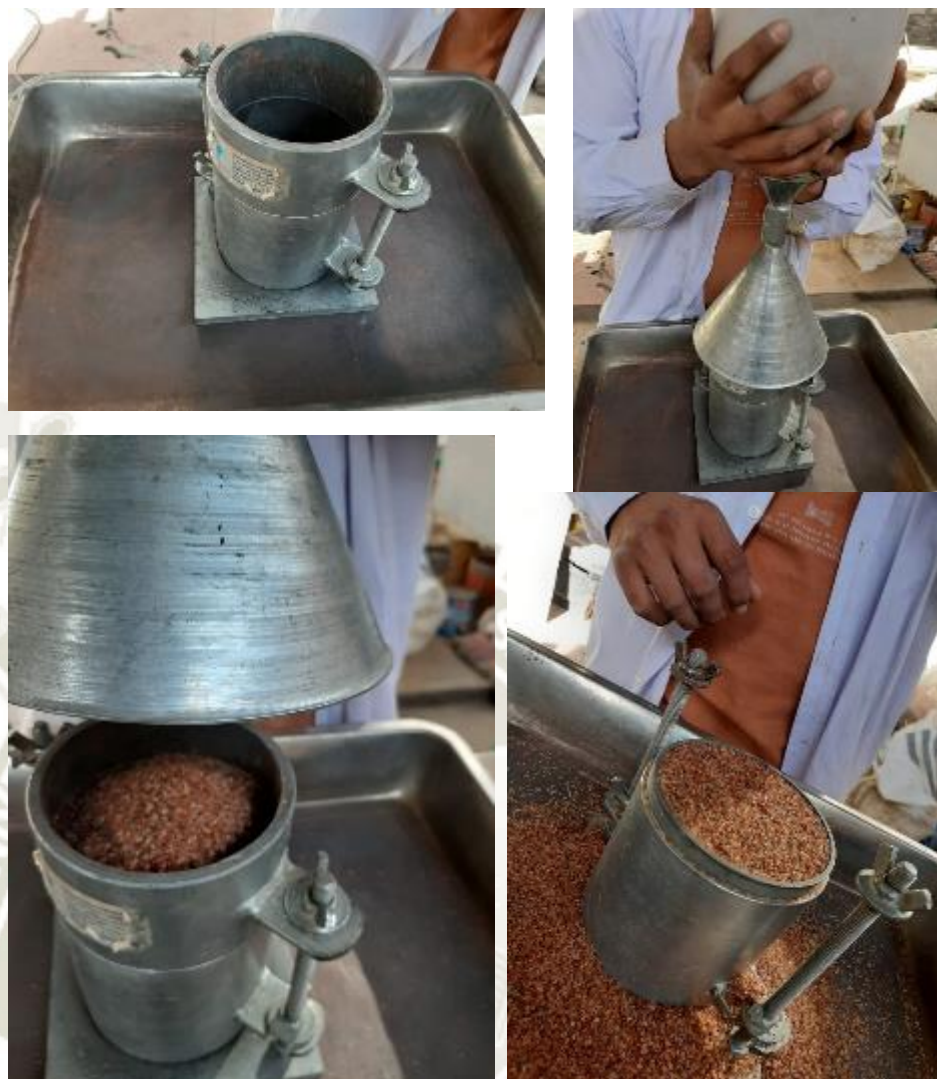
Fotografía 31, Calibración de la densidad de la arena MTC
