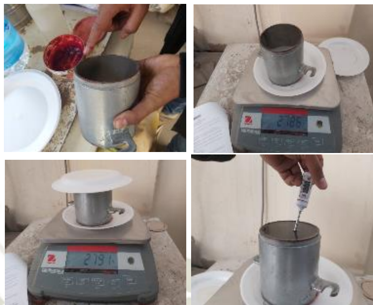
Fotografía 24, Calibración de molde de compactación
