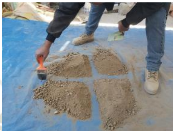
Fotografía 8, Cuarteo de la muestra para ensayos de laboratorio.
