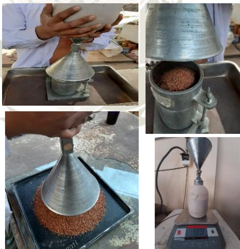
Fotografía 35, Calibración del aparato de cono de arena ASTM
