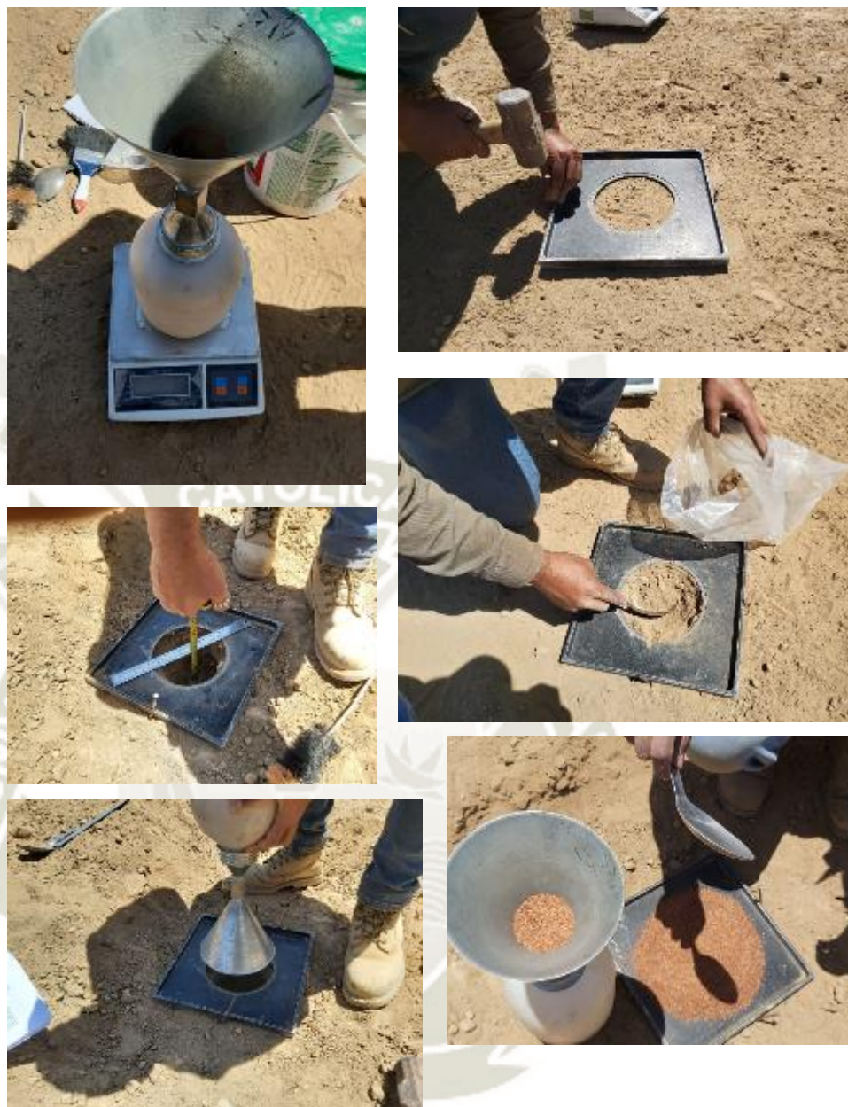
Fotografía 30, Ensayo de cono de arena NTP
