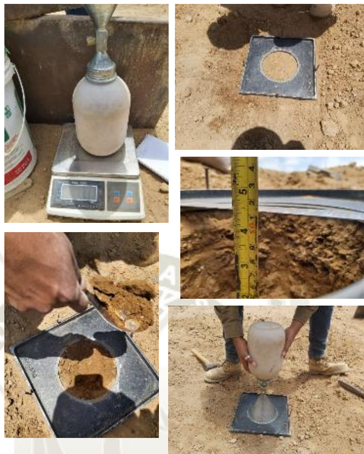
Fotografía 33, Ensayo de cono de arena MTC
