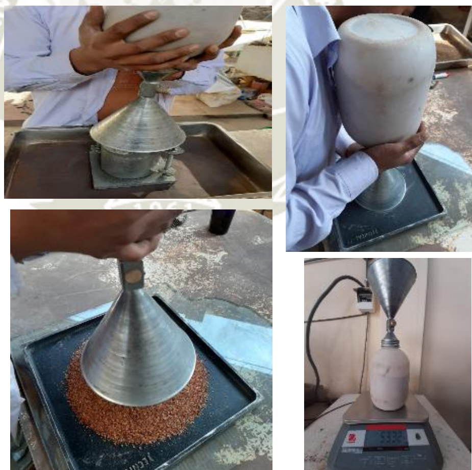
Fotografía 32, Calibración del aparato de cono de arena MTC
