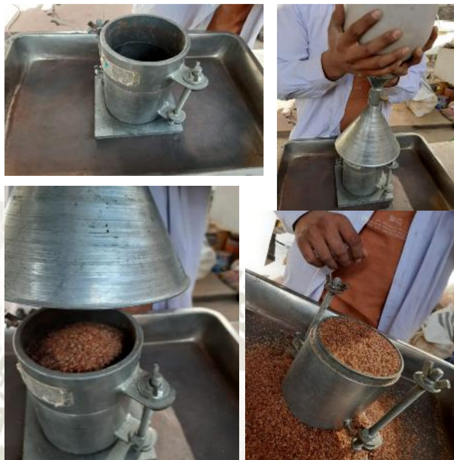
Fotografía 28, Calibración de la densidad de la arena NTP
