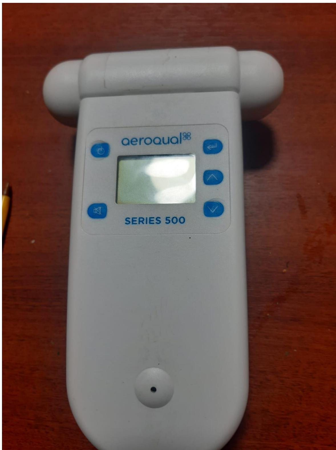
Figura 19. Equipo Aeroqual S500 con sensor de CO
