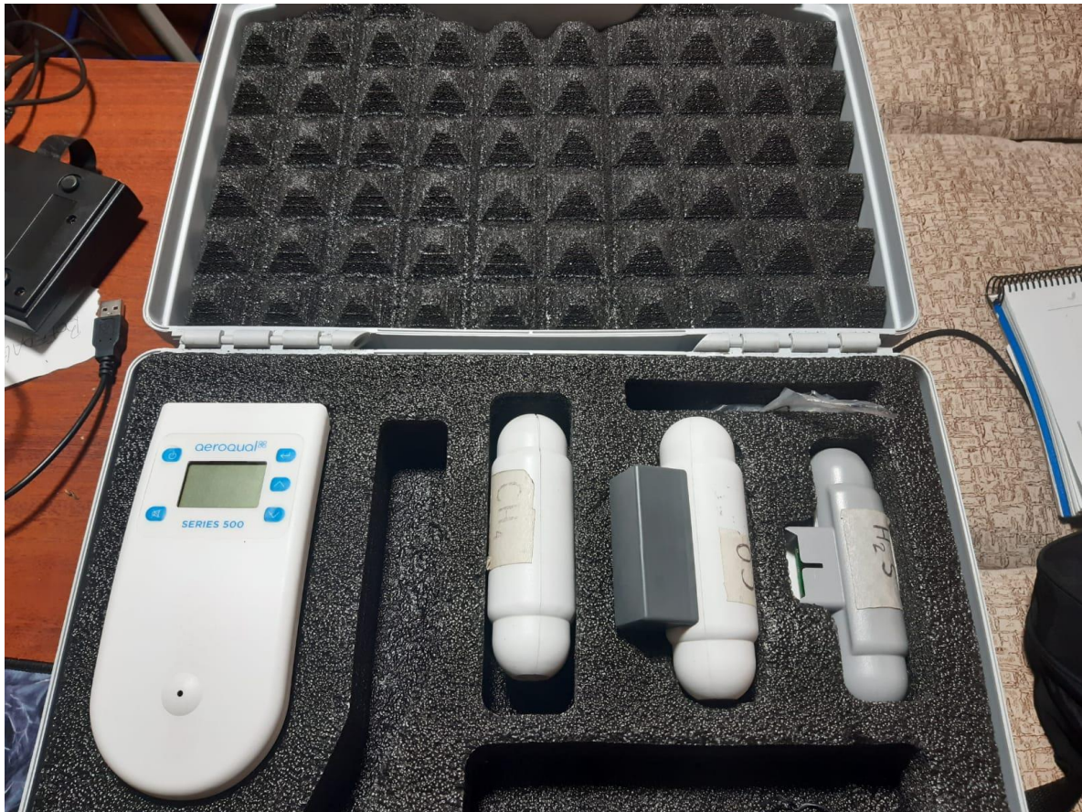
Figura 18. Maletín con el equipo Aeroqual S500 con los sensores de CO
