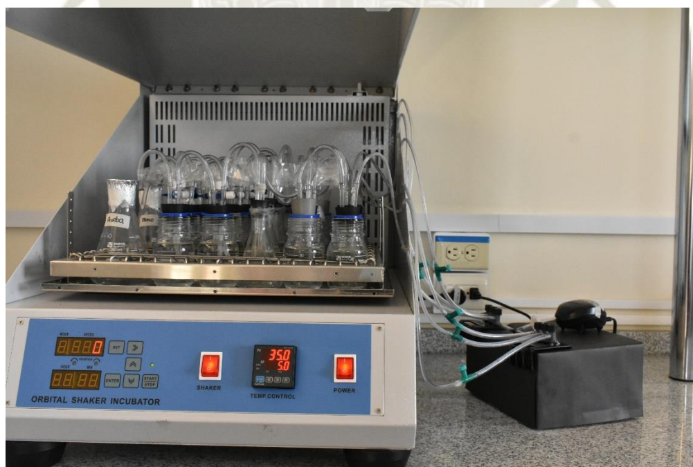
Figura 41. Sistema completo para evolución de CO 2
