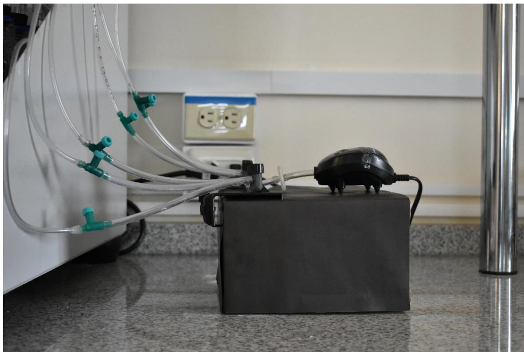
Figura 40. Perfil del sistema de aireación
