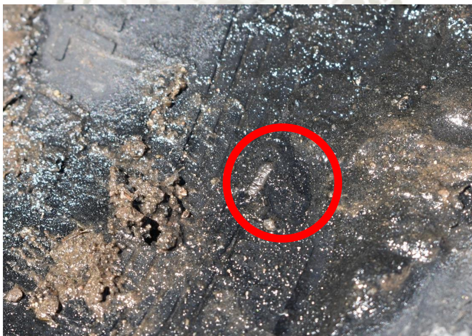
Figura 38. Presencia de larvas en la superficie y grietas de la llanta
