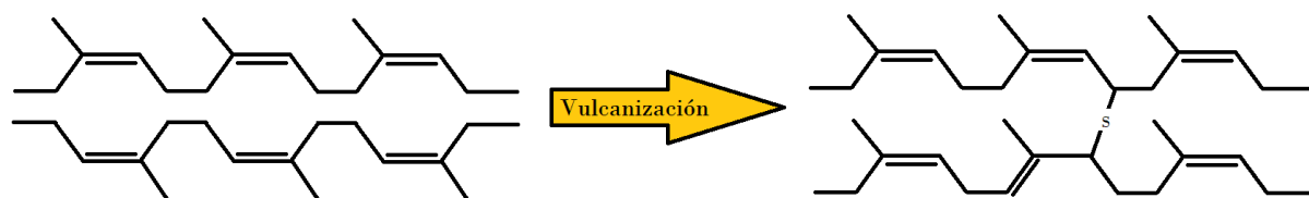
Figura 2. Vulcanización del caucho (Kumar & Nijasure, 1997)
