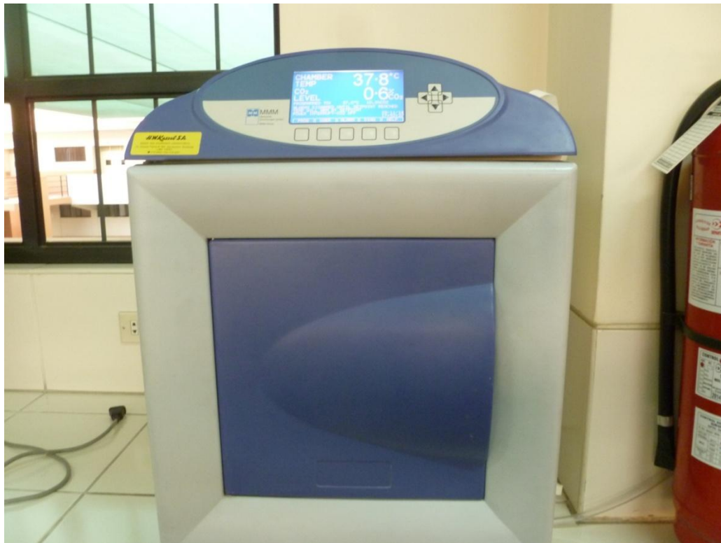
Cámara de anaerobiosis a una temperatura de 37°C y CO_2 al 10%
