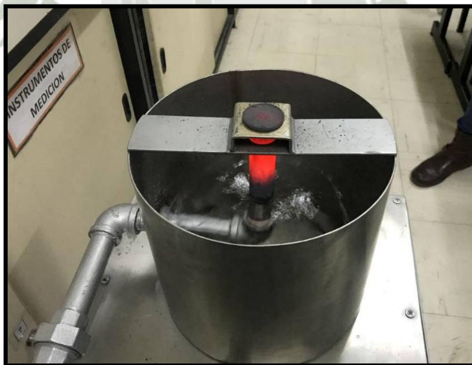
FIGURA 70: ENFRIAMIENTO DE PROBETA JOMINY
