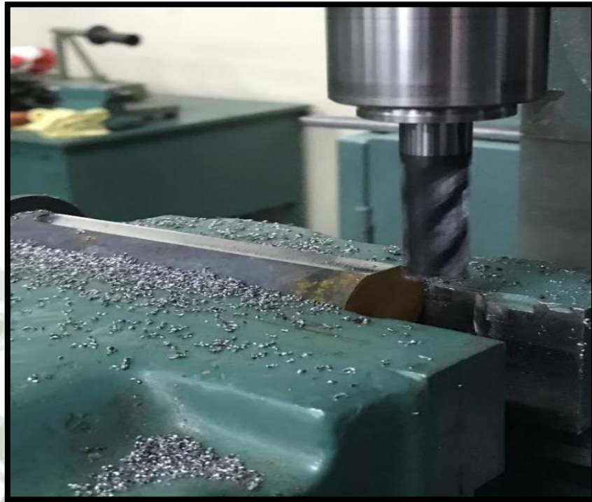
FIGURA 74: MAQUINADO DE PROBETAS JOMINY – FRESADO
