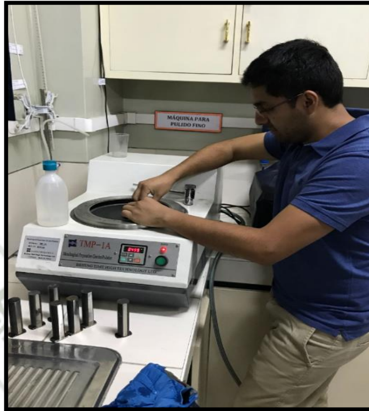
FIGURA 76: PULIDO DE PROBETAS JOMINY
