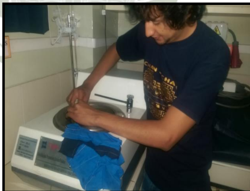
FIGURA 77: PULIDO DE PROBETAS JOMINY EN MAQUINA DE PULIDO
