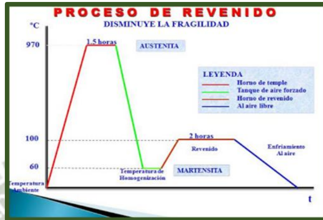
FIGURA 3: PROCESO DE REVENIDO
