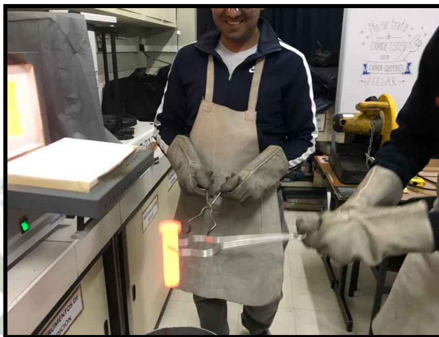
FIGURA 67: RETIRO DE PROBETA JOMINY – HORNO ELÉCTRICO
