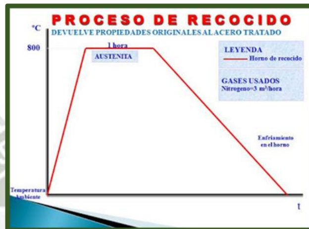
FIGURA 5: PROCESO DE RECOCIDO
