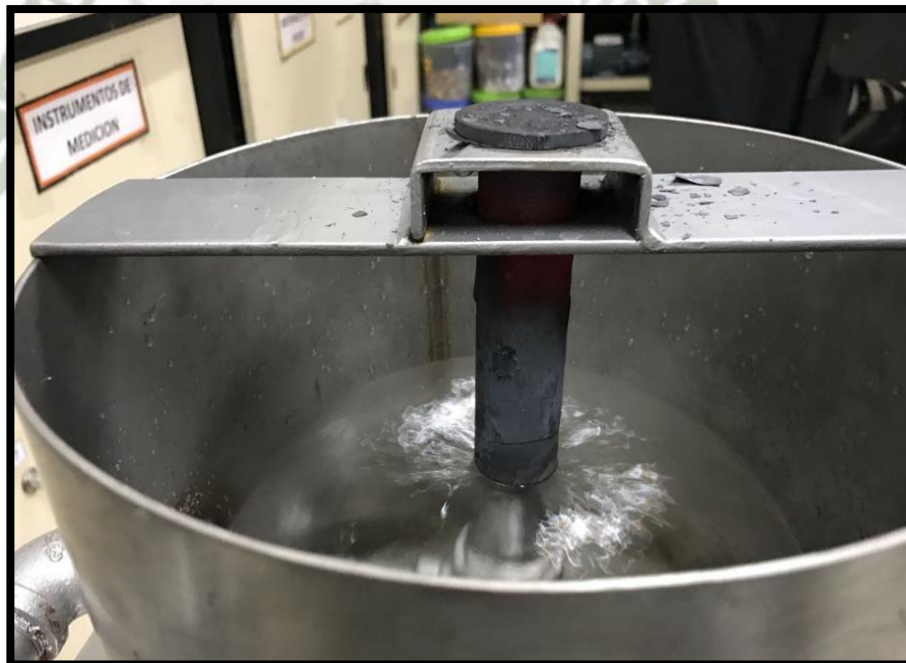
FIGURA 72: ENFRIAMIENTO DE PROBETA JOMINY ETAPA – FINAL
