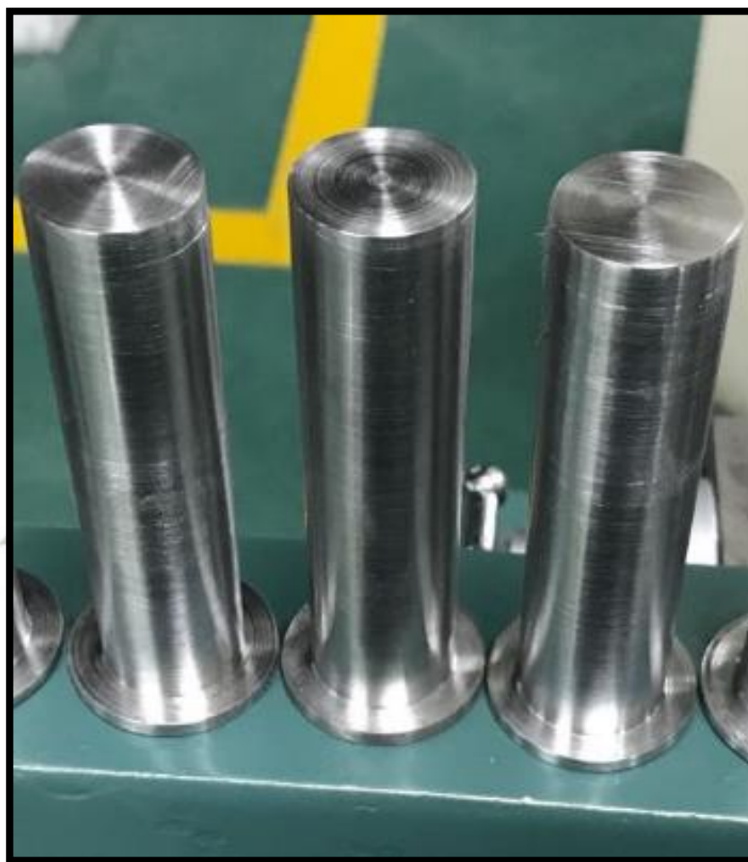
FIGURA 64: PROBETA DE ACERO TORNEADA – ACABADO
