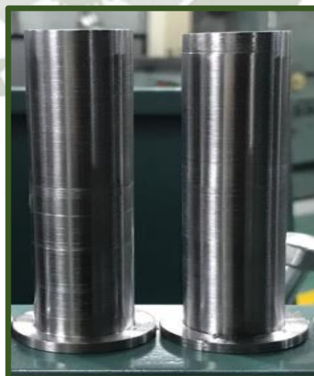
FIGURA 14: PROBETA PARA ENSAYO JOMINY
