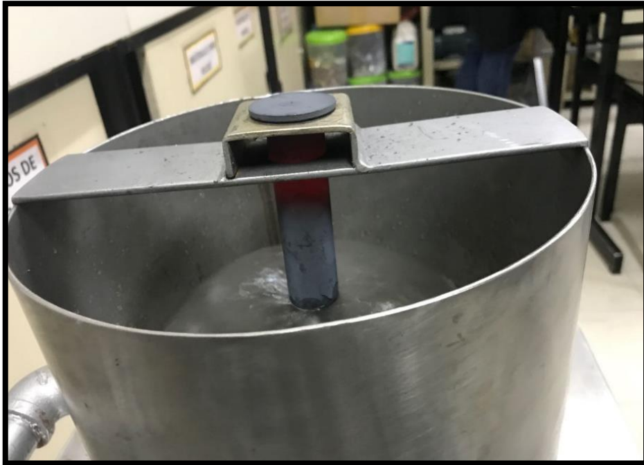
FIGURA 71: ENFRIAMIENTO DE PROBETA JOMINY ETAPA - MEDIA
