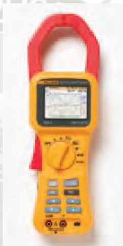
Figura 15: Equipo portátil de calidad de la energía
