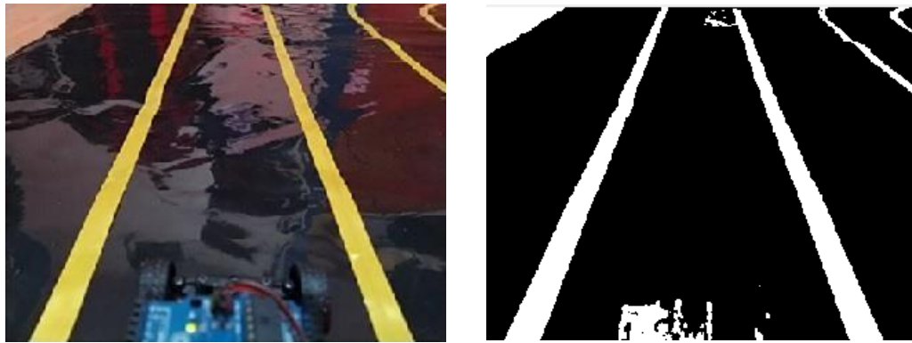
Figura IV.17 Ejemplo del funcionamiento de las transformaciones globales del sistema Fuente: Elaboración propia
