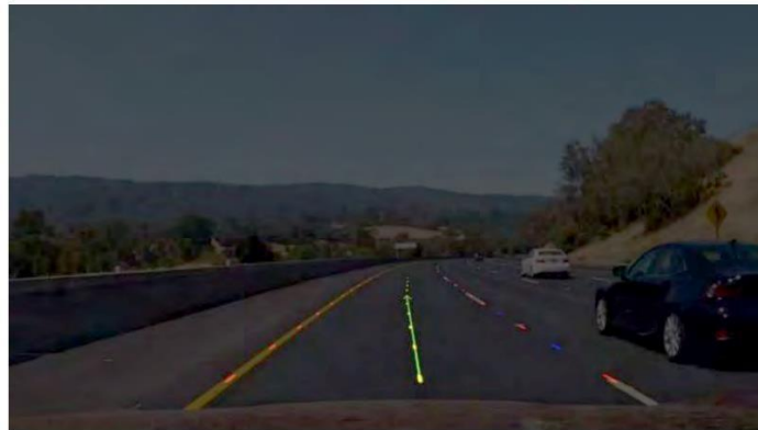
Figura I.13 Vector de dirección obtenido de la detección de carril
