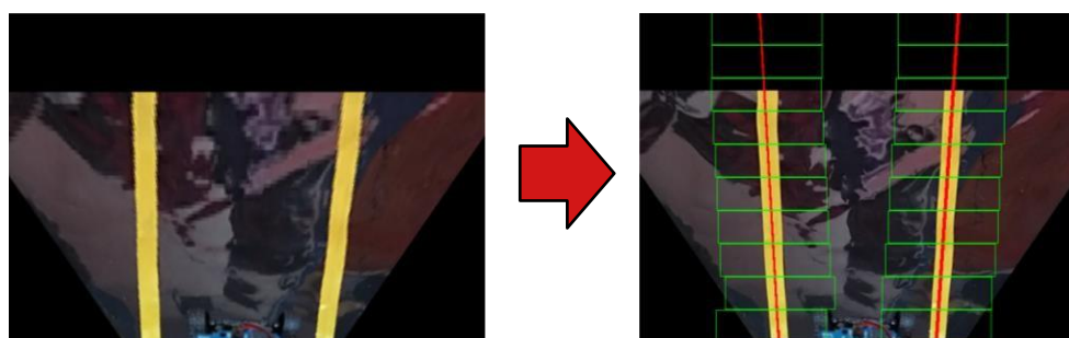
Figura IV.21 Ejemplo del bloque de procesamiento de imagen Fuente: Elaboración propia
