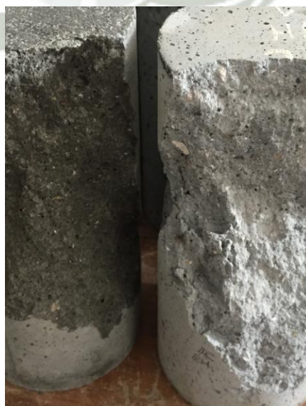
Ilustración 19: Probeta Curada en Autoclave VS probeta curada en Agua
