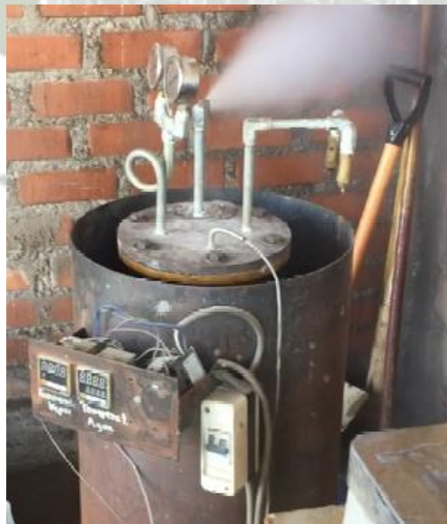
Ilustración 10: Expulsión del vapor de agua del equipo de curado
