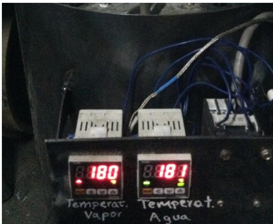
Ilustración 14: Temperatura vapor y agua
