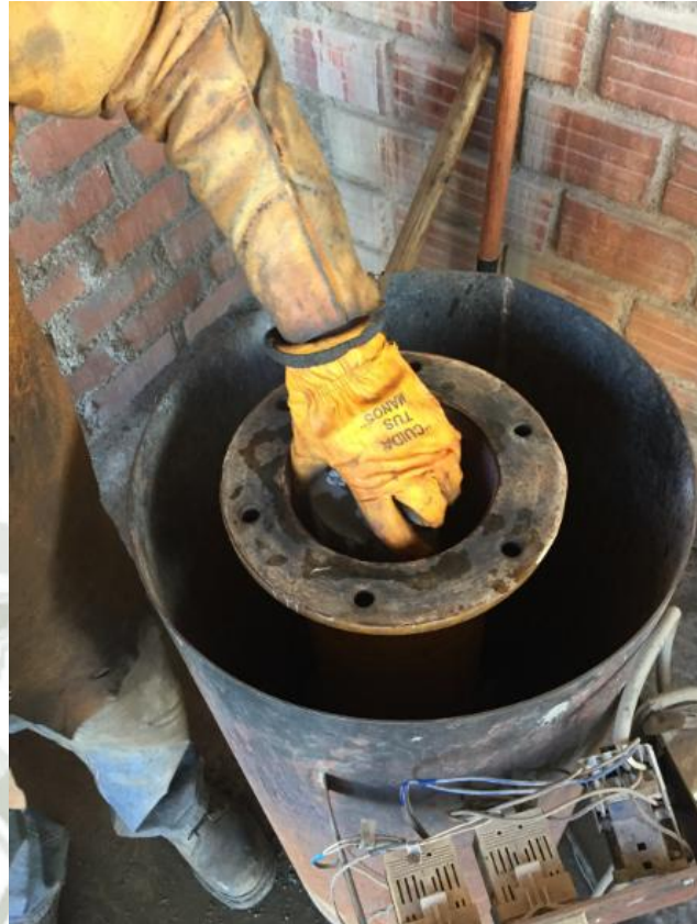
Ilustración 6: Extracción de especímenes de concreto del equipo de curado
