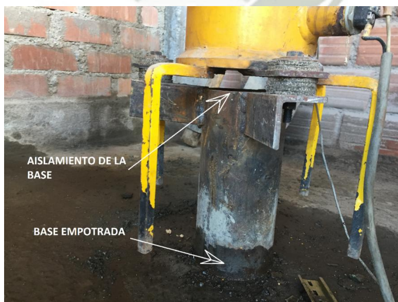
Ilustración 1: Aislamiento de base de equipo de curado en autoclave.
