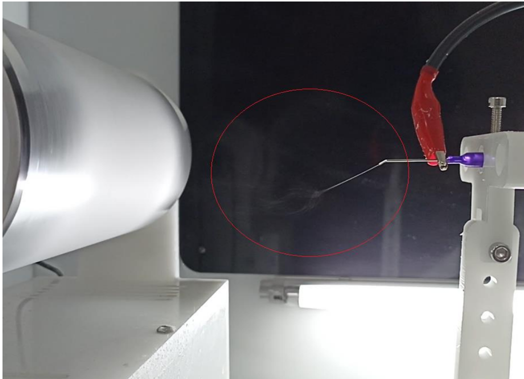
Figura 4.28 Inyección de solución polimérica al 13% (p/v) y formación de cono de Taylor en proceso de electrohilado del ensayo final 04
