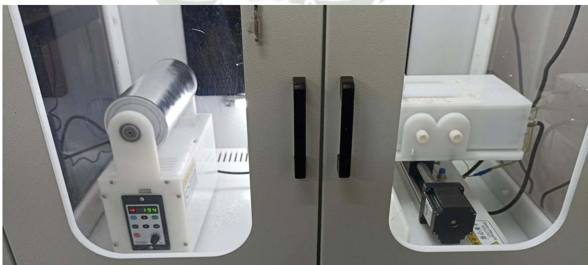
Figura 3.13 Cámara de máquina de electrohilado con puertas cerradas
