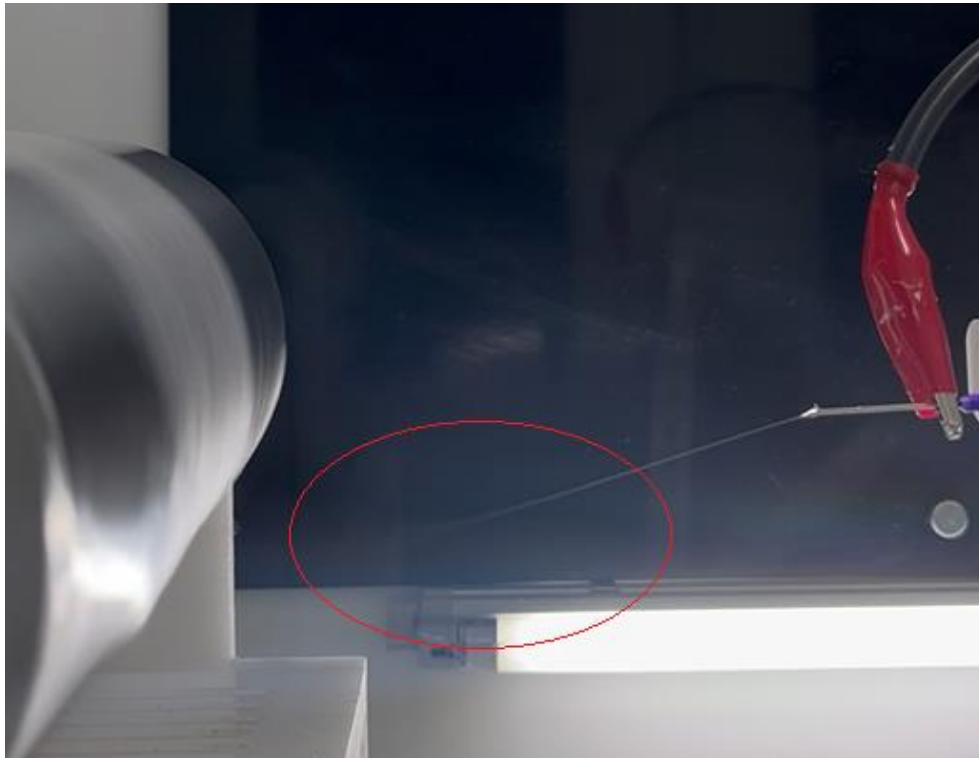
Figura 4.42 Inyección de solución polimérica al 18% (p/v) y formación de cono de Taylor en proceso de electrohilado del ensayo final 09
