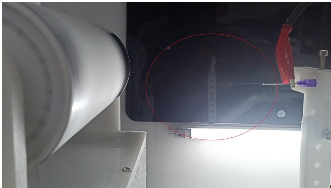
Figura 4.26 Inyección de solución polimérica al 13% (p/v) y formación de cono de Taylor en proceso de electrohilado del ensayo final 02
