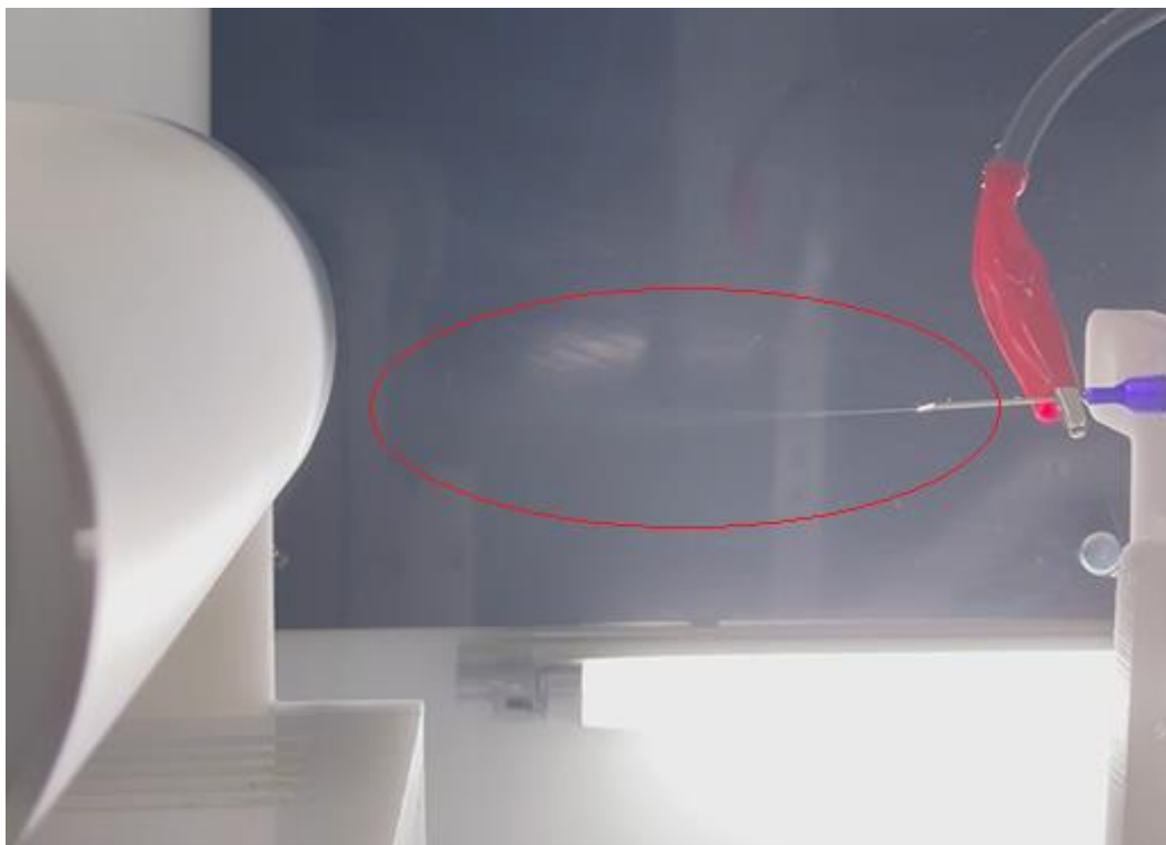
Figura 4.36 Inyección de solución polimérica al 18% (p/v) y formación de cono de Taylor en proceso de electrohilado del ensayo final 03
