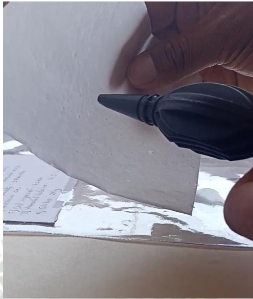
Figura 4.15 Inspección de la membrana de su permeabilidad con el aire
