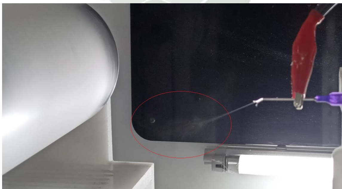
Figura 4.33 Inyección de solución polimérica al 13% (p/v) y formación de cono de Taylor en proceso de electrohilado del ensayo final 09
