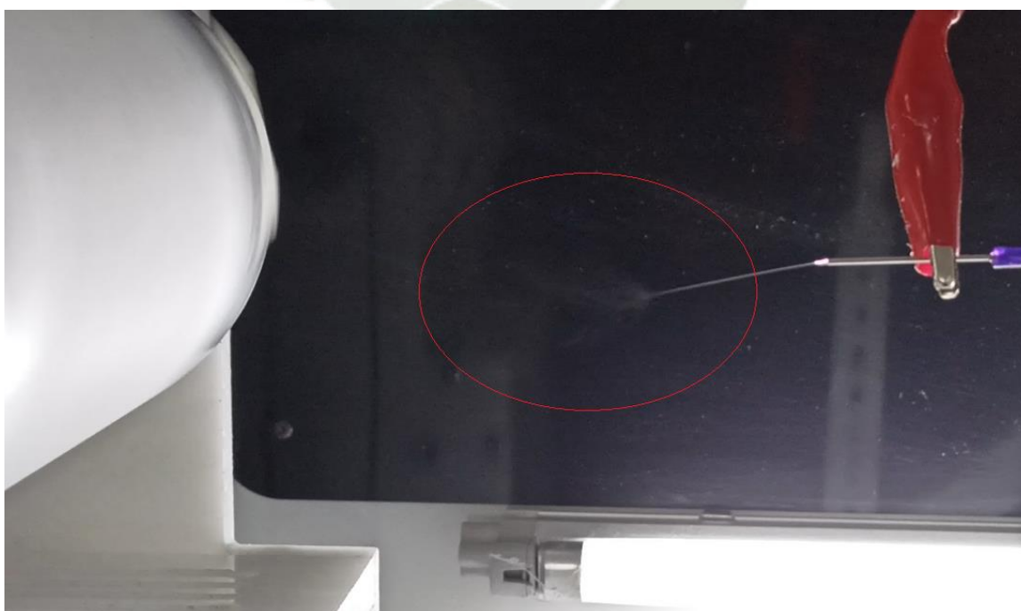
Figura 4.29 Inyección de solución polimérica al 13% (p/v) y formación de cono de Taylor en proceso de electrohilado del ensayo final 05
