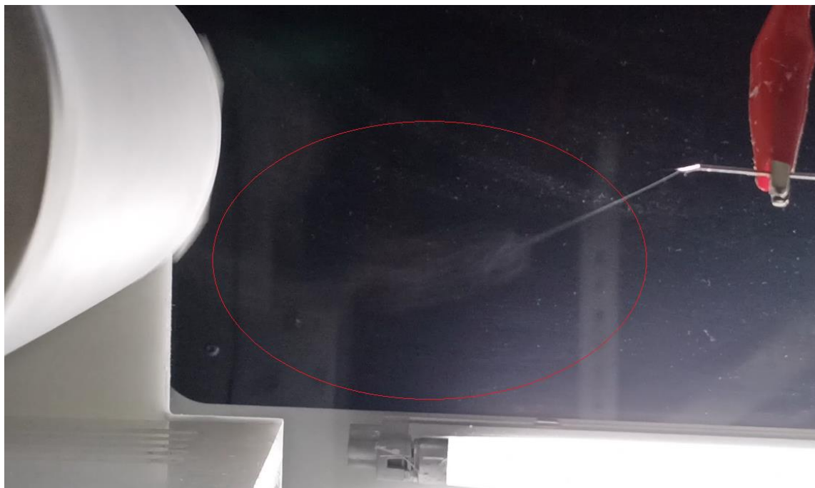
Figura 4.32 Inyección de solución polimérica al 13% (p/v) y formación de cono de Taylor en proceso de electrohilado del ensayo final 08
