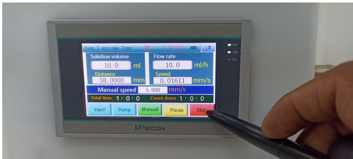
Figura 3.18 Display que muestra la opción de detenido de la bomba de inyección
