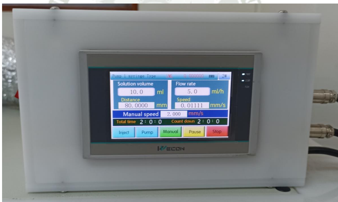
Figura 3.5 Configuración del controlador de bombas
