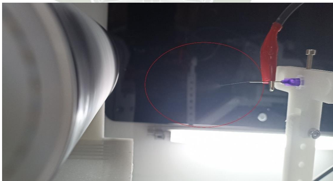
Figura 4.25 Inyección de solución polimérica al 13% (p/v) y formación de cono de Taylor en proceso de electrohilado del ensayo final 01
