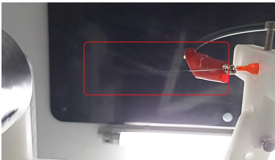
Figura 4.6 Inyección de solución polimérica y formación del cono de Taylor
