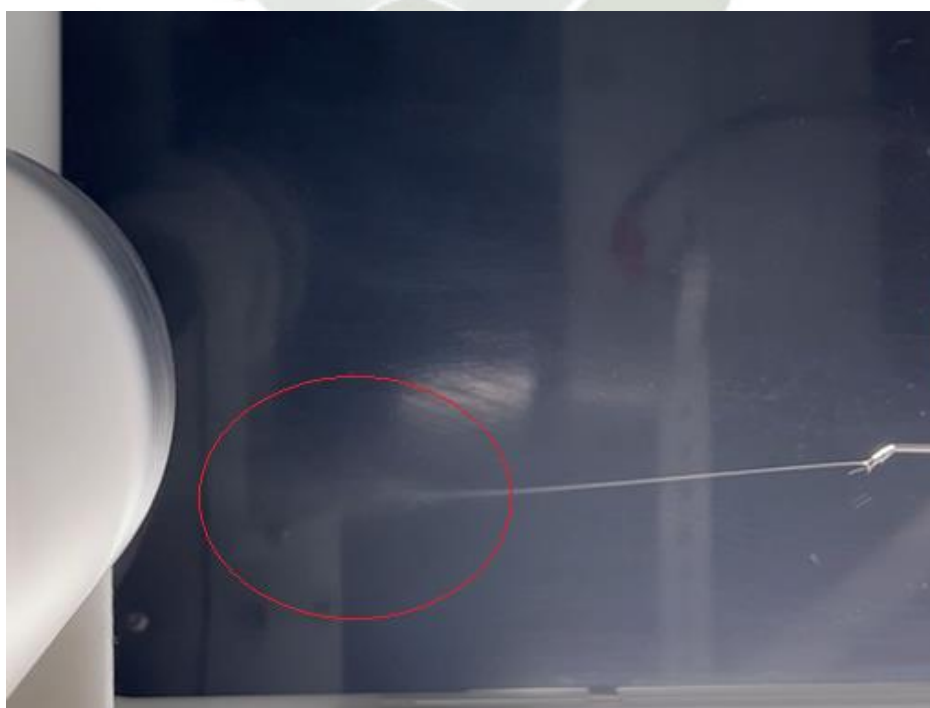
Figura 4.35 Inyección de solución polimérica al 18% (p/v) y formación de cono de Taylor en proceso de electrohilado del ensayo final 02
