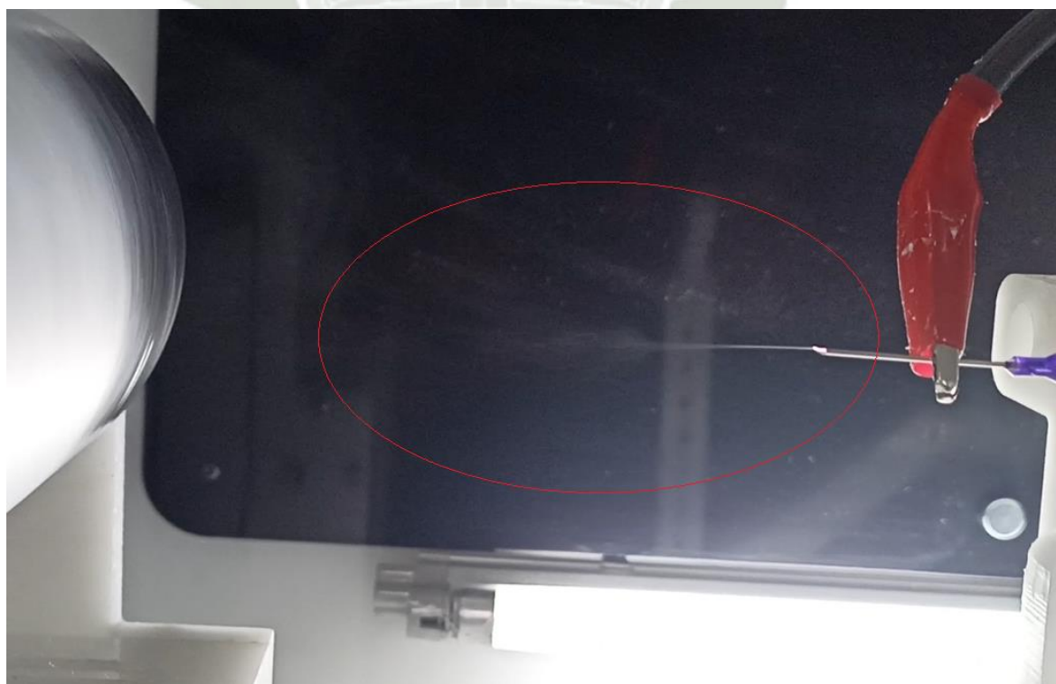
Figura 4.31 Inyección de solución polimérica al 13% (p/v) y formación de cono de Taylor en proceso de electrohilado del ensayo final 07
