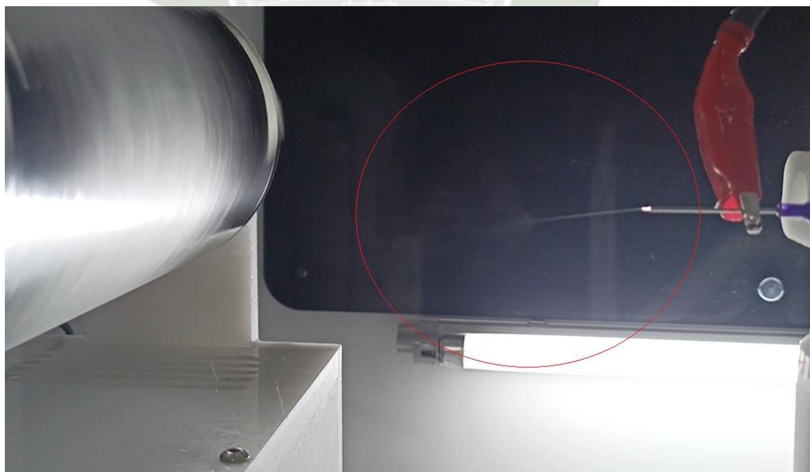
Figura 4.27 Inyección de solución polimérica al 13% (p/v) y formación de cono de Taylor en proceso de electrohilado del ensayo final 03
