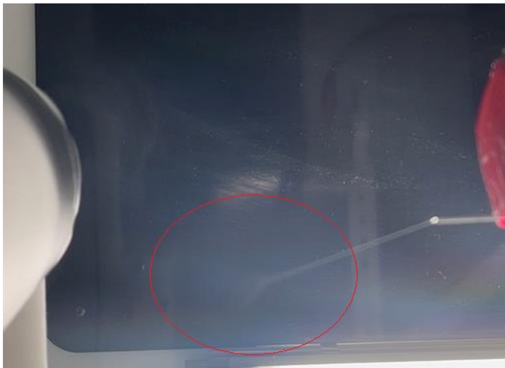
Figura 4.40 Inyección de solución polimérica al 18% (p/v) y formación de cono de Taylor en proceso de electrohilado del ensayo final 07
