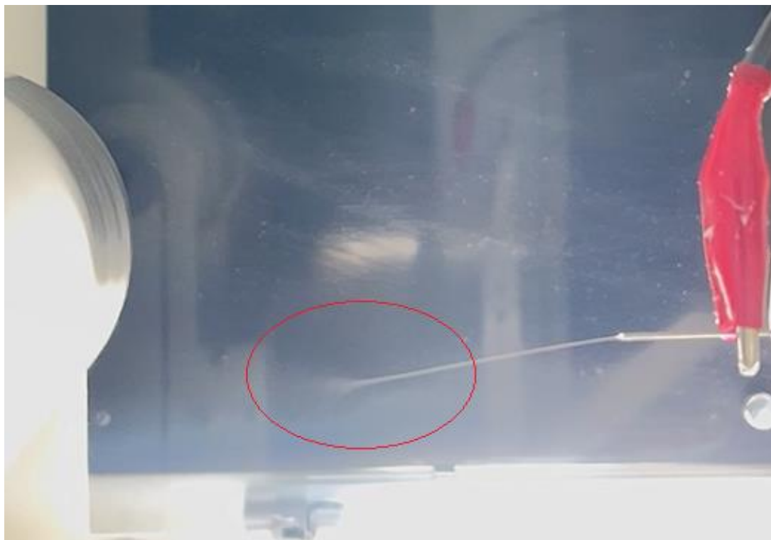
Figura 4.38 Inyección de solución polimérica al 18% (p/v) y formación de cono de Taylor en proceso de electrohilado del ensayo final 05
