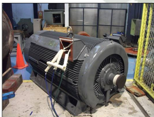
Fotografía N° 5.10.- Prueba en Vacío - Alimentación de Tensión.
