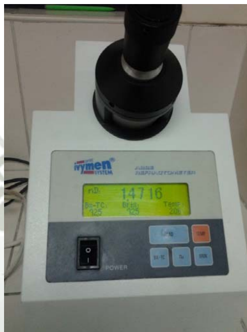
Figura N° 12.- Determinación del índice de refracción a través del refractómetro.
