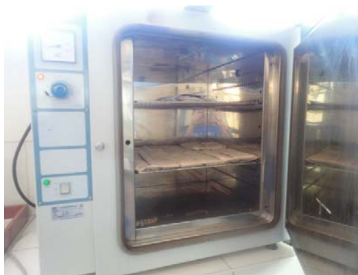
Figura N° 8.- Secado de las semillas en la estufa a 40 °C.
