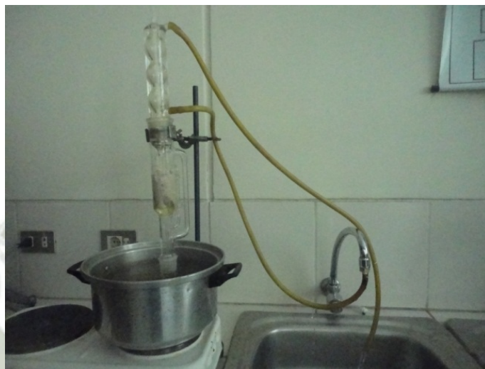
Figura N° 10.- Extracción del aceite con el equipo Soxhlet.
