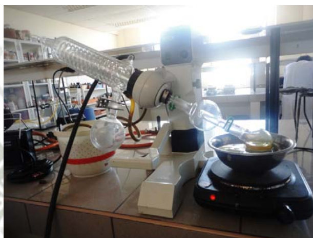
Figura N° 11. Concentrado de la muestra por medio del rotavapor.
