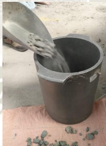
Ilustración 29. Peso Unitario Suelto Grueso
