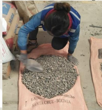
Ilustración 6. Muestro de agregado
