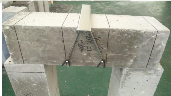
Ilustración 64. Colocación de barra central
