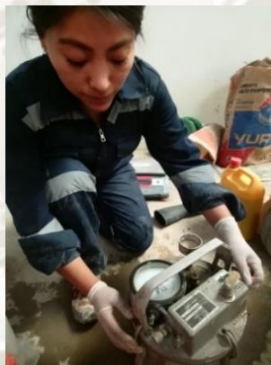
Ilustración 56. Contenido de Aire
