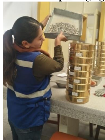
Ilustración 7. Tamices para agregado grueso
