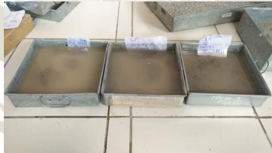
Ilustración 32. Muestras de fino Saturando
