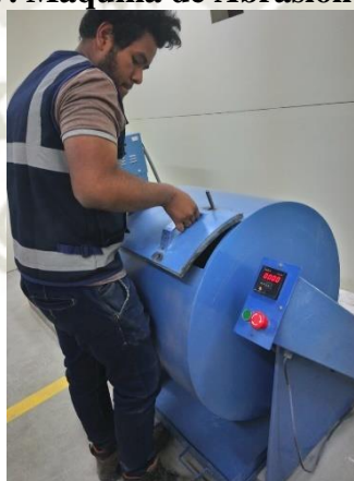
Ilustración 37. Máquina de Abrasión de los Ángeles
