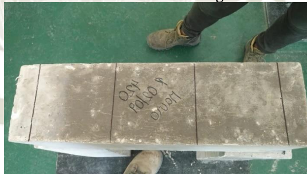
Ilustración 62. Marcación de la viga a dos tercios
