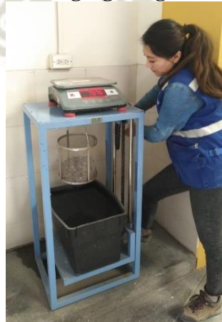
Ilustración 36. Agregado grueso sumergido
