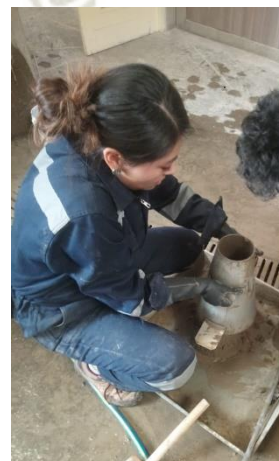
Ilustración 51. Retiro de cono Slump
