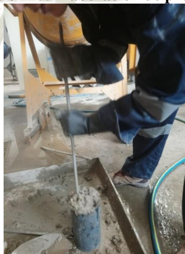
Ilustración 45. Elaboración de probetas
