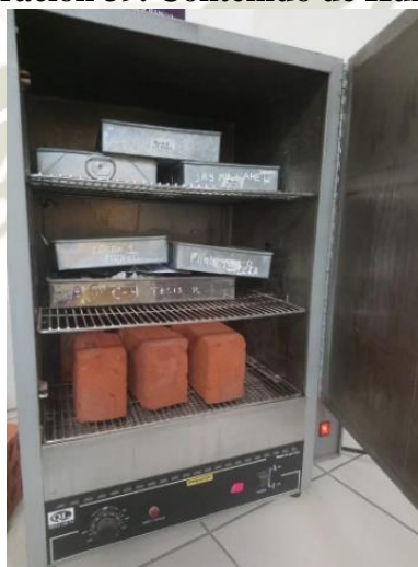
Ilustración 39. Contenido de Humedad
