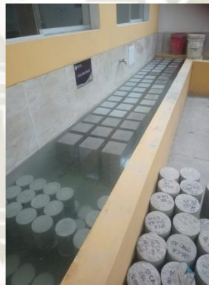
Ilustración 48. Fosa de curado de vigas
