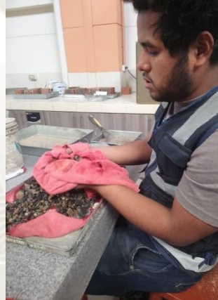
Ilustración 35. Agregado grueso superficialmente seco
