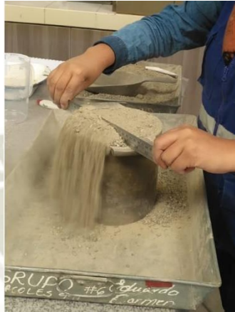
Ilustración 28. Peso Unitario Suelto Fino
