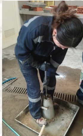
Ilustración 50. Varillado de asentamiento
