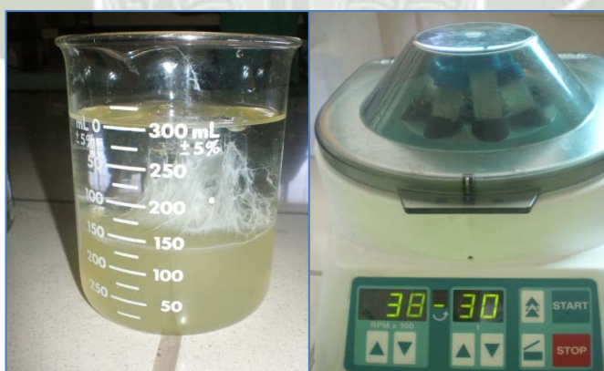
FIGURA 2.4. Proceso de purificación del mucílago de semillas de tara (de izquierda a derecha), purificación utilizando etanol 96% y centrifugación.
