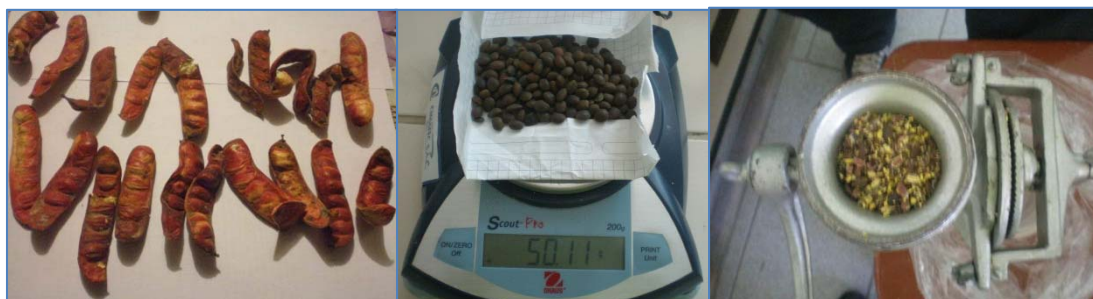
FIGURA 2.2. Extracción de mucílago de tara por vía seca (de izquierda a derecha): Vainas de Tara, Pesado de las semillas, Lisis de las semillas por trituración con molino.
