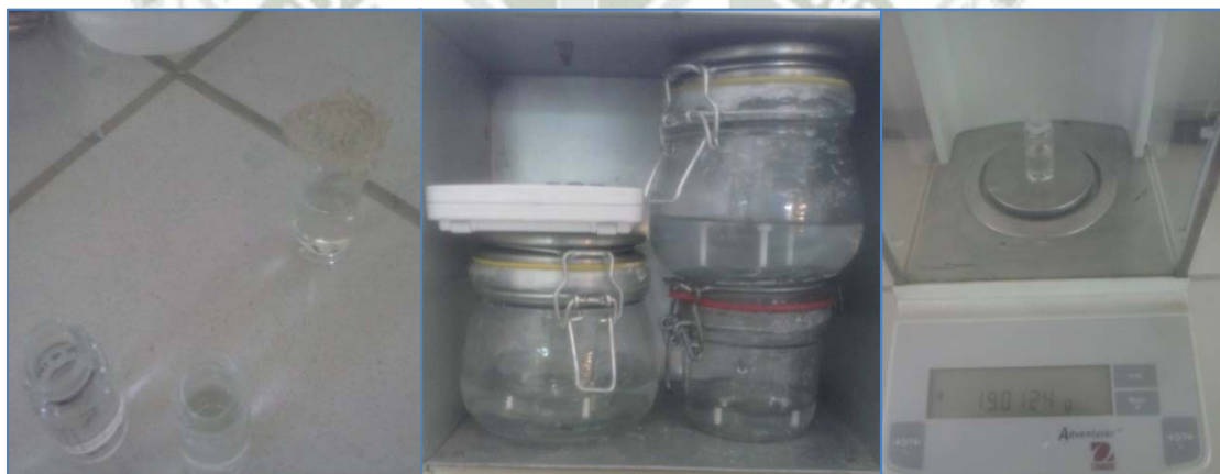
FIGURA 2.13. Ensayo de Permeabilidad al Vapor de Agua (de derecha a izquierda): Viales con KNO 3 y el biopolímero, arreglo de envases dentro de la cámara ambiental, pesado periódico de viales.
