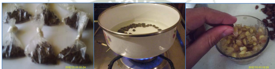
FIGURA 2.3. Extracción de mucílago de tara por vía húmeda (de izquierda a derecha): 250 semillas de tara agrupadas, Cocción de las semillas, Extracción mecánica de las semillas.
