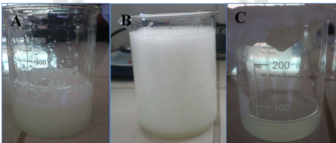
FIGURA 3.1. Mucílago de Sábila extraído por: A) Homogenización y decantación, B) Homogenización y Filtrado al Vacío, C) Molienda Coloidal
