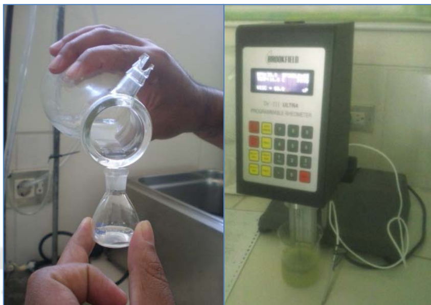
FIGURA 2.14. (De derecha a izquierda) Determinación gravimétrica de la densidad, Reómetro empleado en la determinación de la viscosidad.
