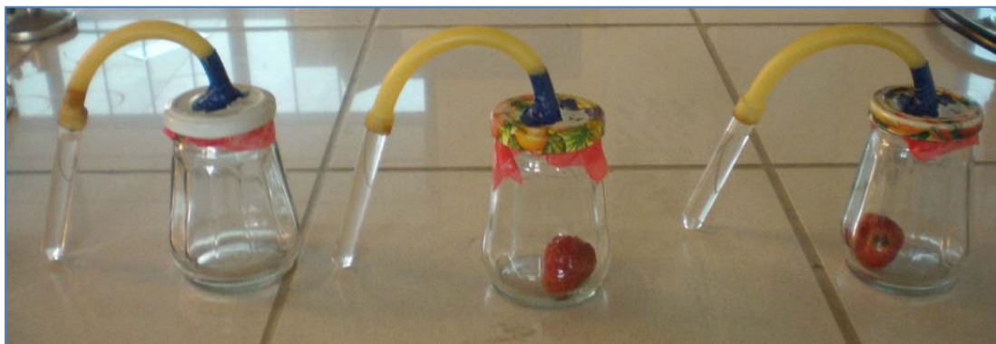
FIGURA 2.11. Ensamblado de frascos para la prueba de tasa de respiración.
