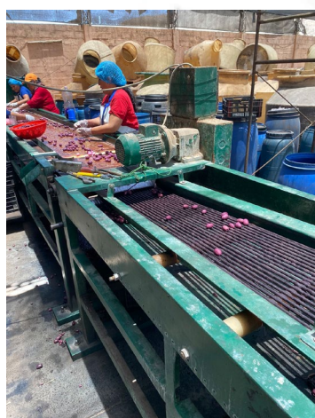
Máquina calibradora que clasifica las aceitunas por su tamaño
