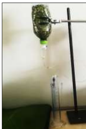
Figura 5. Sistema de percolación preparado en el laboratorio Fuente: Elaboración propia
