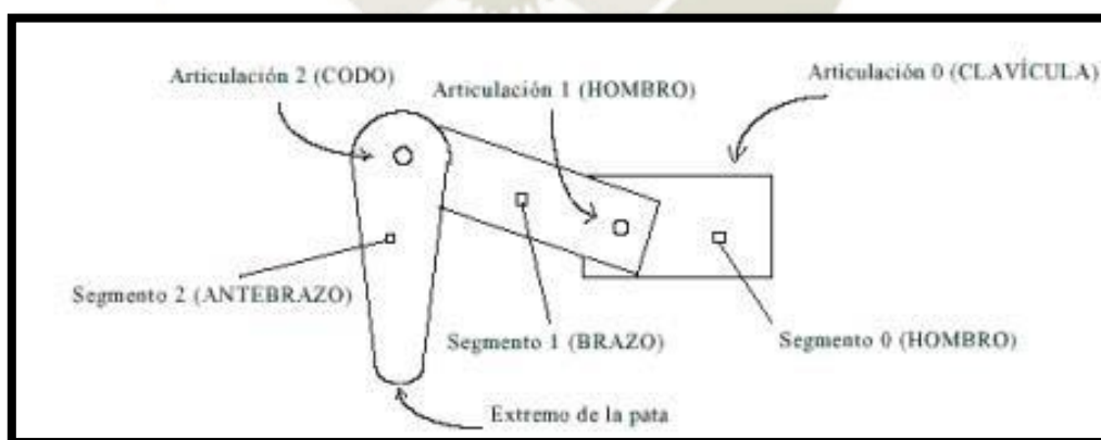
Figura 31. Bosquejo de pata completa y sus articulaciones.
