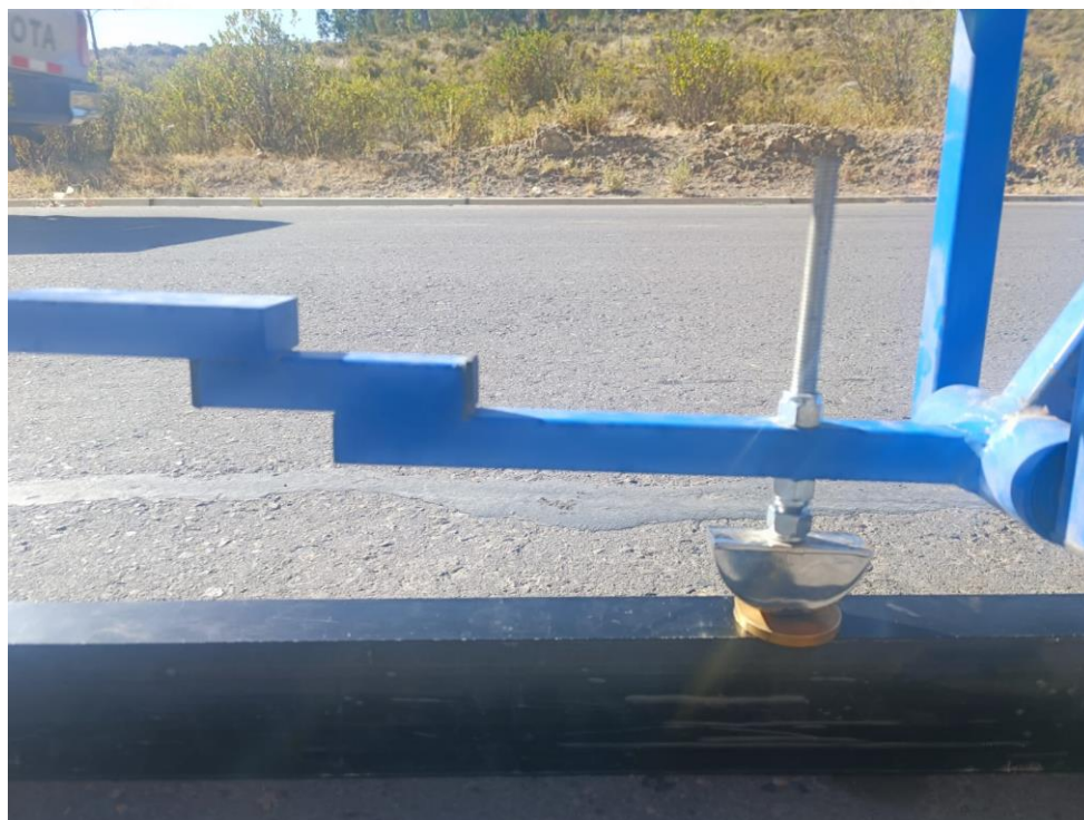
Calibración insitu del Rugosímetro de Merlin
