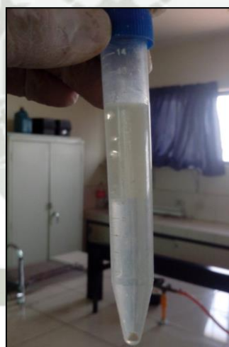
2. 17 Pellet de biosurfactante precipitado mediante centrifugación luego de la acidificación del caldo.
