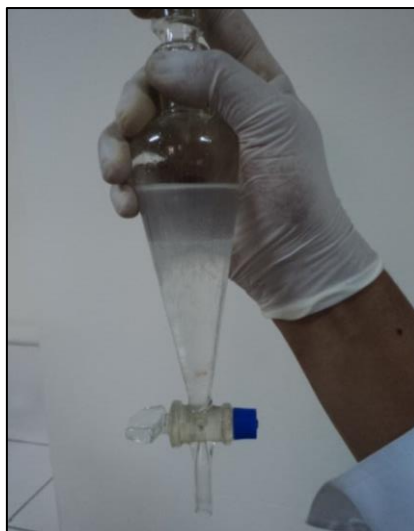
2. 18 Extracción líquido-líquido del biosurfactante mediante una mezcla de cloroformo-metanol.
