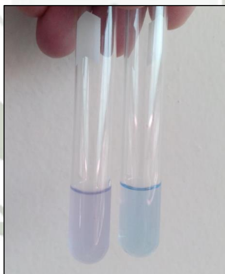
Figura N° 36: Resultado de la prueba de Biuret. Nótese la solución de biosurfactante positiva para esta prueba comparada con el control negativo.
