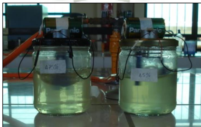
2. 9 Recipientes de cultivo con su sistema de agitación acoplado a ellos en pleno funcionamiento.
