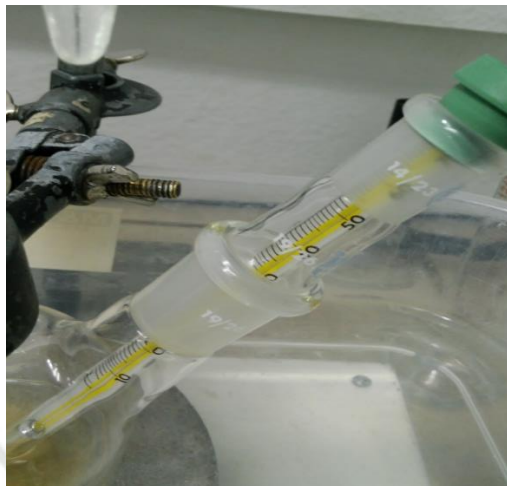
Figura 6: Incremento de la temperatura al entrar en contacto el ácido y la amina, en la síntesis de PIL, alrededor de 60°C
