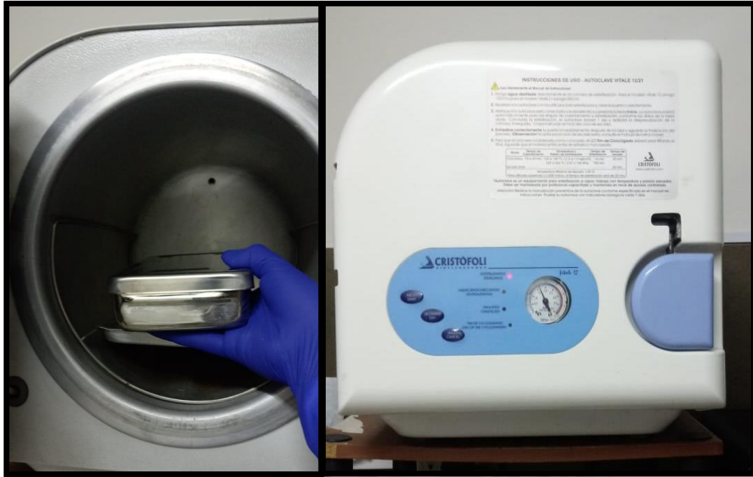
FOTO N°3 ESTERILIZACIÓN DE CARTUCHOS Y TAPONES EN AUTOCLAVE (CALOR HÚMEDO)
