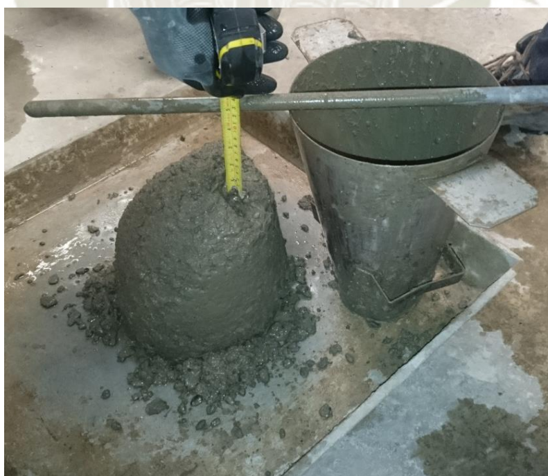
Ilustración 56: Medición de Slump.
