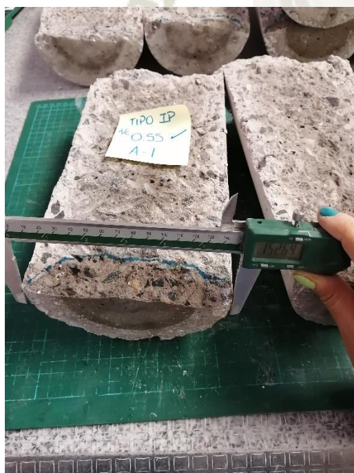
Ilustración 61: Medición de base de concreto húmedo.
