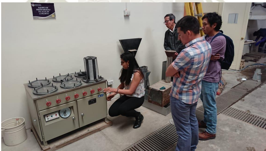
Ilustración 70: Ensayo de permeabilidad al concreto.
