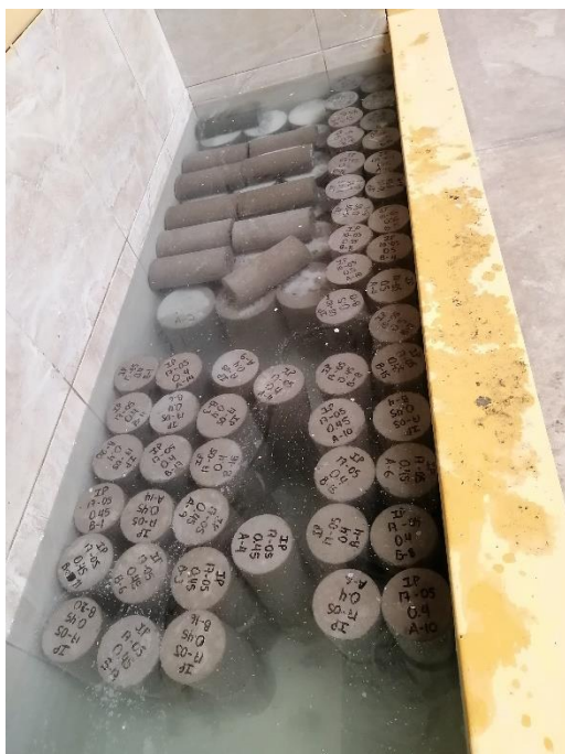
Ilustración 63: Probetas en pozo de curado.
