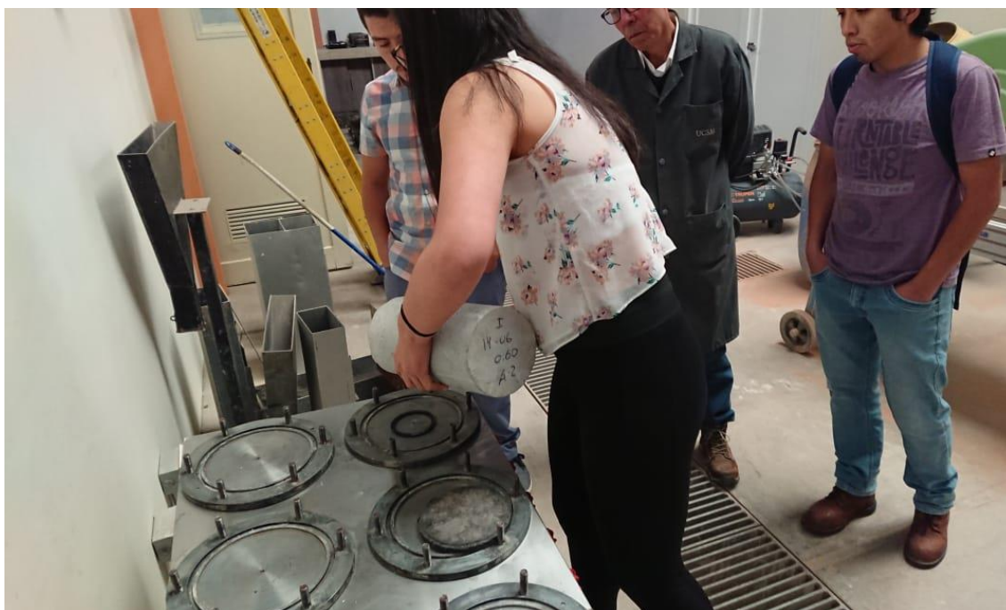
Ilustración 69: Preparación del ensayo de permeabilidad.
