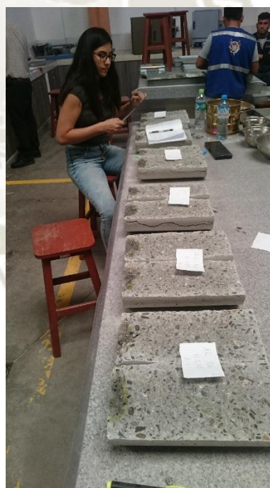
Ilustración 62: Probetas ensayadas por permeabilidad.
