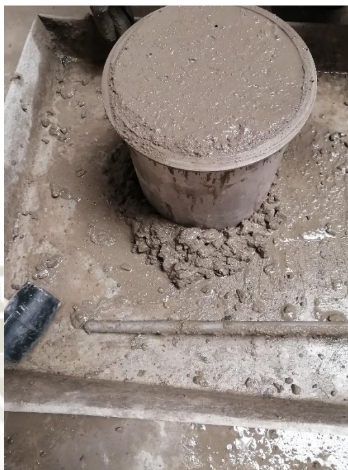
Ilustración 55: Molde para medición de peso unitario.
