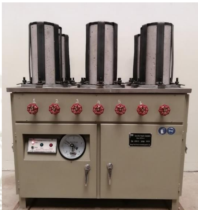
Ilustración 72: Máquina de permeabilidad al agua del concreto.
