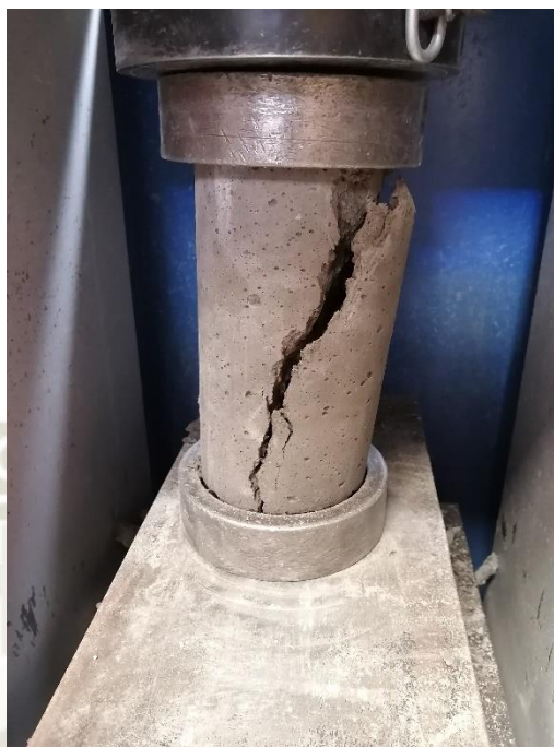
Ilustración 64: Falla por compresión.
