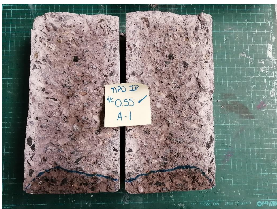
Ilustración 60: Probeta ensayada por permeabilidad.
