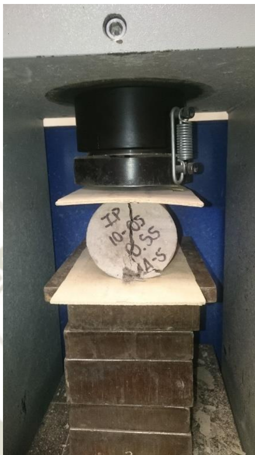
Ilustración 66: Falla por tracción.
