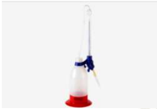
Figura 42: Acidímetro de leche
