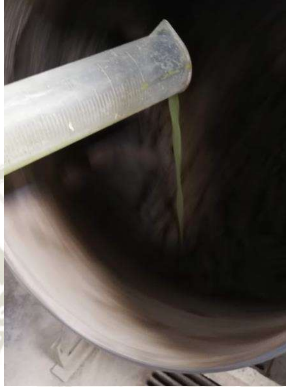
Ilustración 16 Adicionando mucilago de nopal
