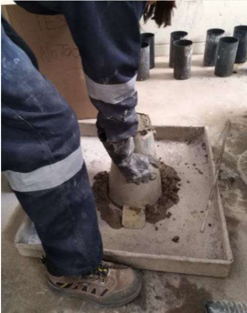
Ilustración 21 Ensayo de asentamiento (Slump)
