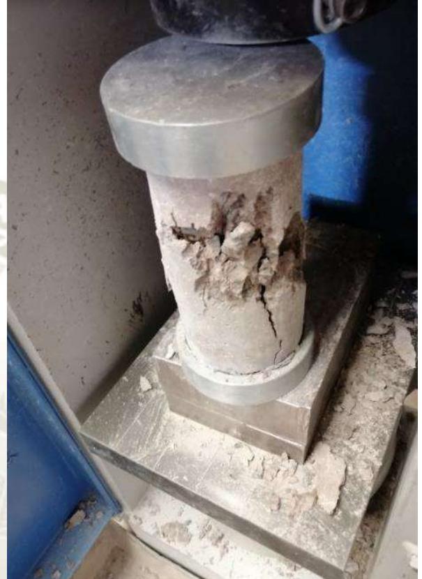
Ilustración 28 Ensayo de resistencia a la compresión
