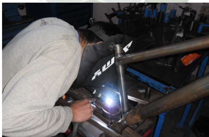
Imagen 5.16 Proceso de soldado de triangulo posterior con soldadura TIG.
