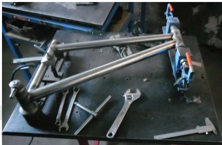
Imagen 5.15 Proceso de soldado de triangulo posterior en matriz.
