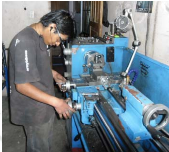
Imagen 5.13 Proceso de torneado de bujes.
