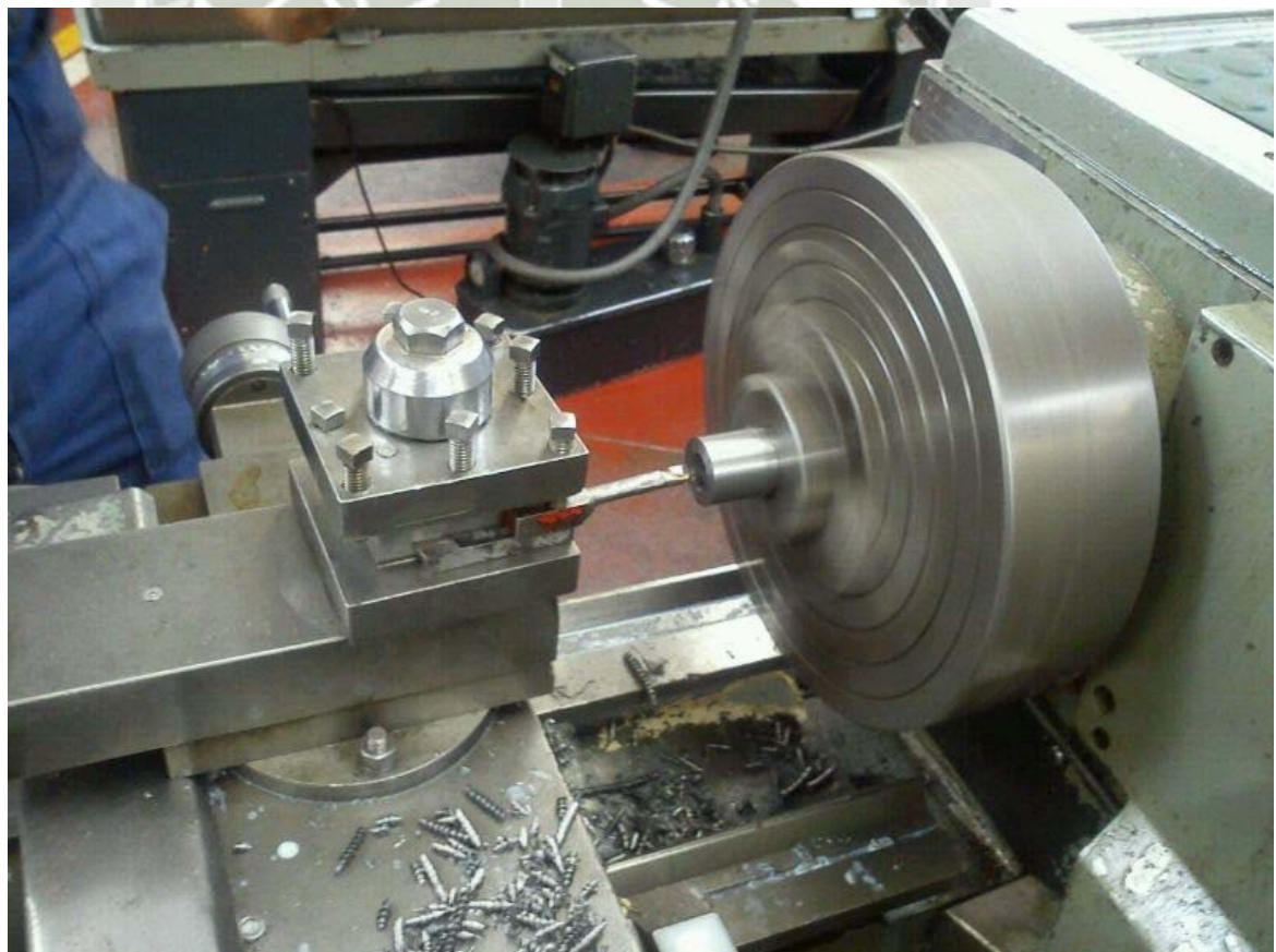
Imagen 5.13 Proceso de torneado de bujes.
