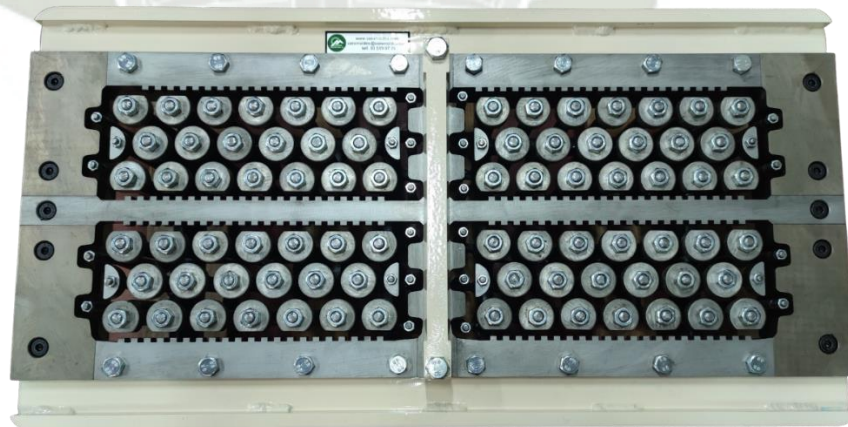
Figura 82 Molde para la fabricación de ladrillos
