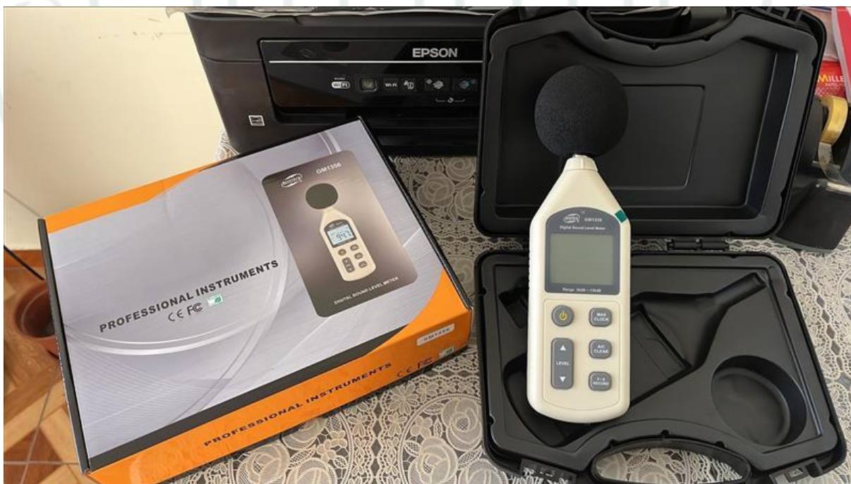
Equipo usado para medición de niveles de sonido resultantes
